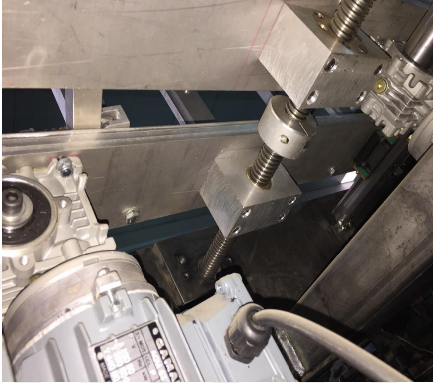
Resim 5.7. En kontrol sağ diş, sol diş ve kaplin bağlantısı
