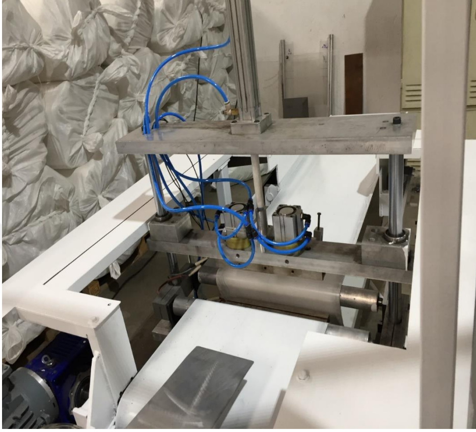
Resim 5.14. Gezer çene bölümü üst piston bağlantısı
