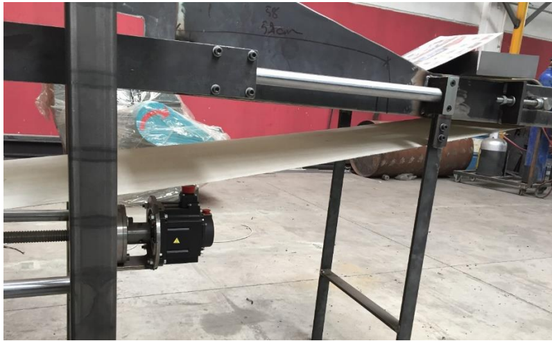
Resim 5.15. Gezer çene bölümü servo motor bağlantısı
