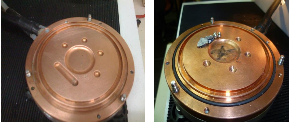
Şekil 3.1. Saf alaşım elementlerinin yerleştirildiği bakır pota
