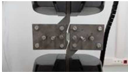
Resim 5.25. Kayma deneyinin yapılması için çekme deney cihazına bağlanan kayma deneyi aparatlarının fotoğrafı
