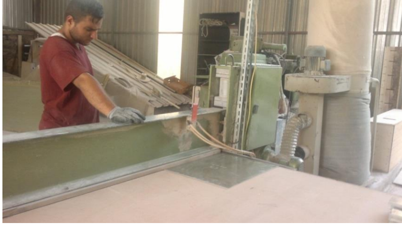
Resim 4.14. Kompozit malzemenin kenarlarının istenilen boyutlara getirilmesi
