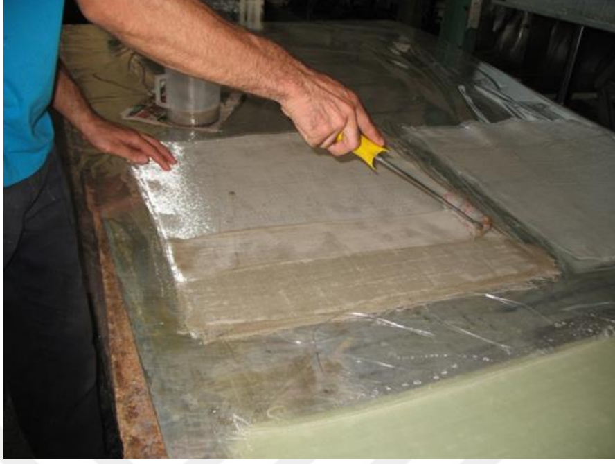
Resim 4.8. Kompozit malzemeye reçine sürülmesi
