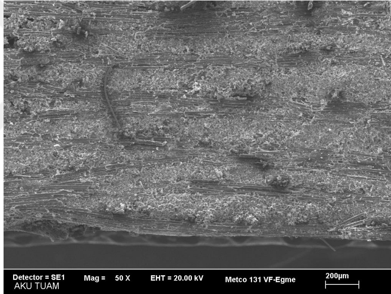
Resim 5.43. Grup H eğilme deney numunesi kırılma yüzeyinin SEM görüntüleri
