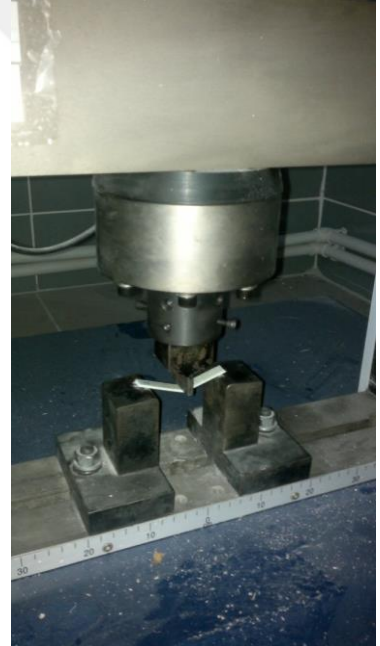
Resim 5.19. Üç noktadan eğilme uygulanan deney numunelerinden bazılarının deney esnasındaki fotoğrafları
