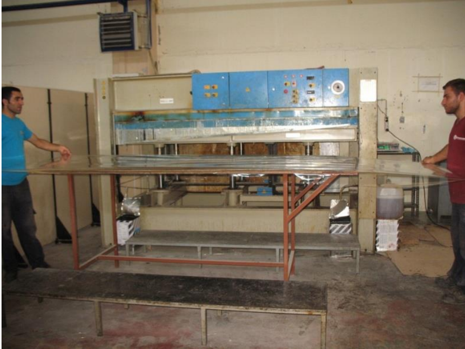
Resim 4.9. Kompozit malzemelerin preste konulmadan önceki görünüşleri
