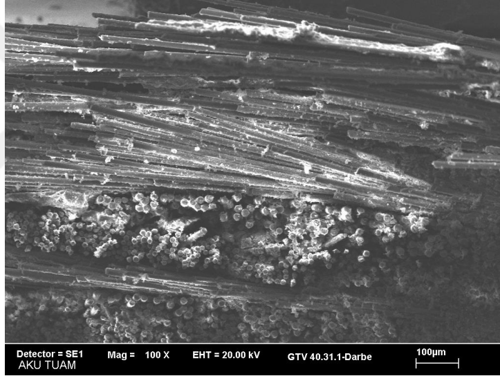
Resim 5.49. Grup G çentik darbe deney numunesi kırılma yüzeyinin SEM görüntüleri
