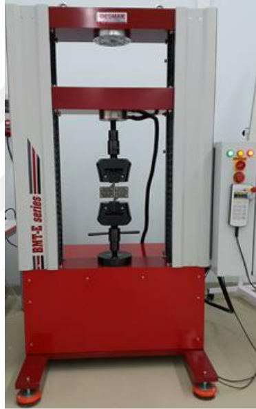
Resim 5.24. Kayma deneyi yapılan çekme cihazının genel görünümü
