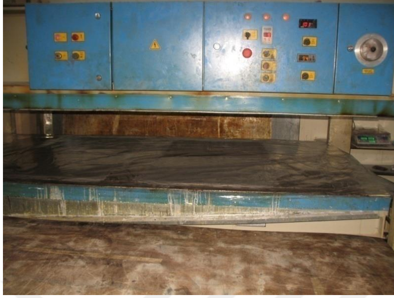
Resim 4.10. Kompozit malzemenin prese yerleştirilmesi
