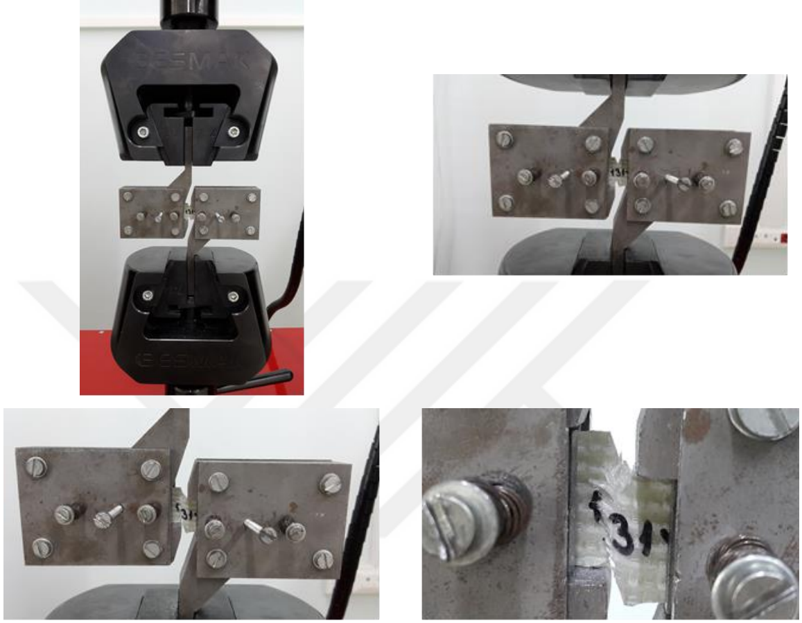
Resim 5.26. Kayma deneyi uygulanan deney numunelerinden bazılarının deney esnasındaki fotoğrafları
