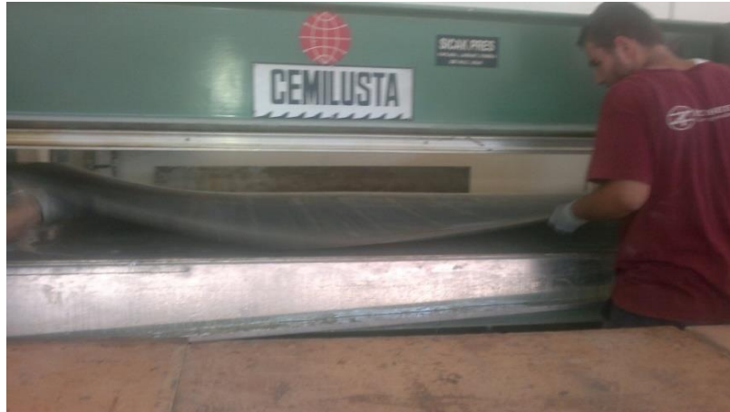
Resim 4.11. Kompozit malzemenin presten çıkarılması
