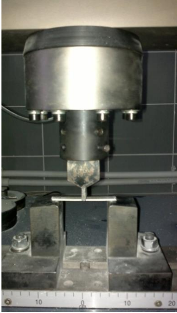
Resim 5.19. Üç noktadan eğilme uygulanan deney numunelerinden bazılarının deney esnasındaki fotoğrafları
