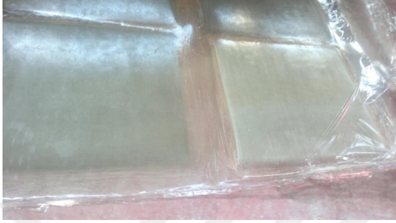
Resim 4.12. Kompozit malzemenin presten çıkarıldıktan sonraki hali
