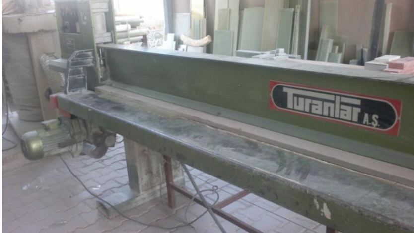
Resim 4.13. Kompozit malzemenin kenarlarının kesilmesinde kullanılan testere
