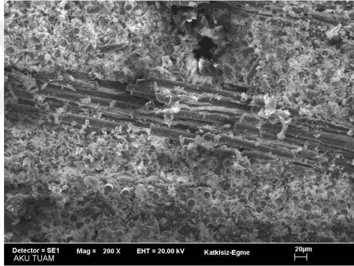
Resim 5.37. Katkısız eğilme deney numunesi kırılma yüzeyinin SEM görüntüleri
