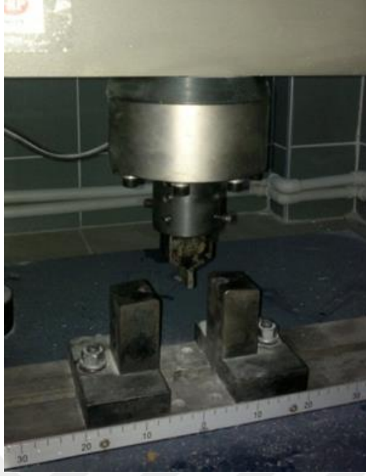
Resim 5.18.Eğilme deney cihazının genel görünümü
