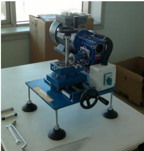
Resim 5.20. Çentik darbe deneyi ve kayma deneyi numunelerine istenilen derinlikte çentik açmak için kullanılan makine
