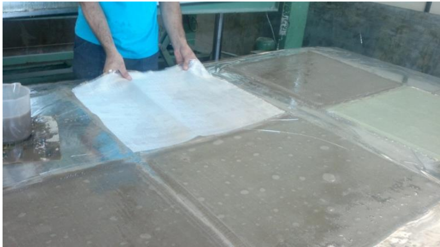
Resim 4.7. Kompozit malzemenin el yatırma yöntemi ile imal edilmesi
