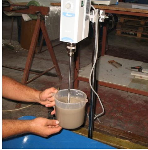
Resim 4.6. Hazırlanan reçine ve seramik tozun mekanik karıştırıcı ile karıştırılması
