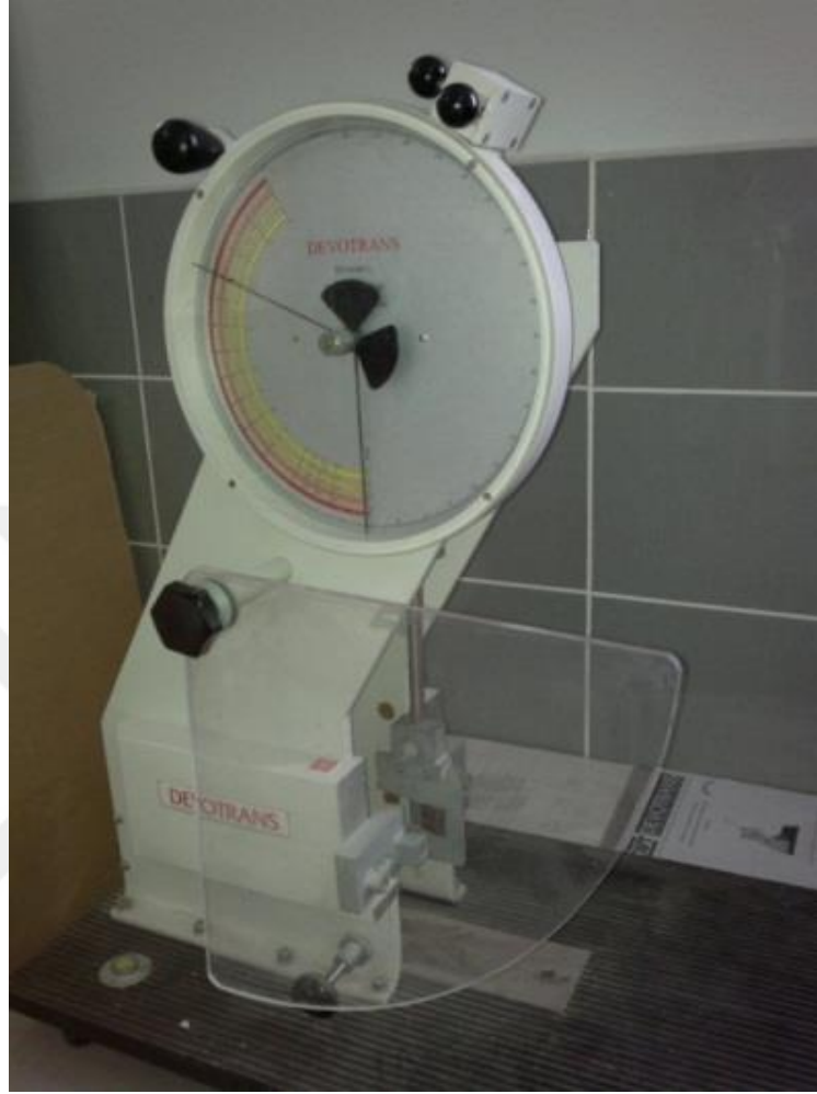
Resim 5.22. Çentik darbe deney cihazının genel görünümü
