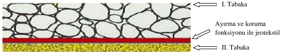
Resim 2.1. Jeotekstillerin ayırma ve koruma fonksiyonu [37]
