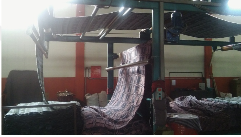
Resim 1.7. Dokunmuş battaniyenin şardonlama ünitesine sevki
