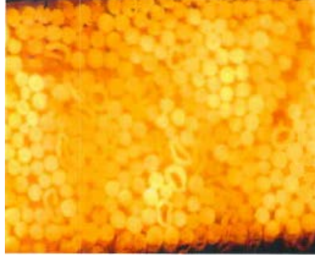
Resim 3.1. Çalışmada kullanılan rPET lifine ait enine kesit görüntüsü
