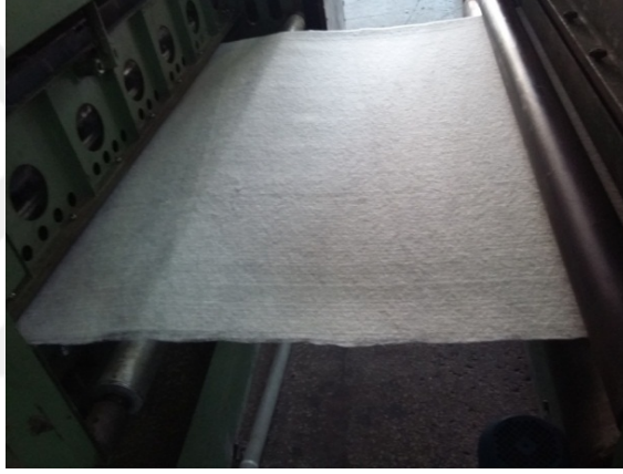
Resim 3.20. İğneleme bölgesinden çıkan dokusuz yüzey kumaş
