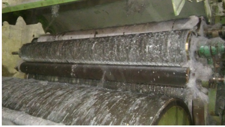
Resim 3.14. Çalışıcı-Sıyırıcı silindir çiftlerinin tarama tamburundaki yerleşimi
