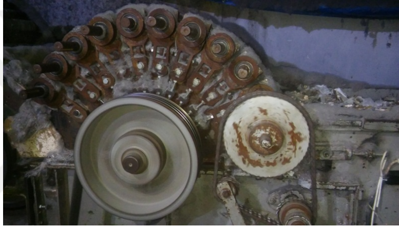
Resim 1.3. Ön tarama tamburu ve tutucu-yolucu silindir çiftleri
