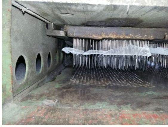
Resim 3.19. İğne tablasındaki iğnelerin yerleşimi
