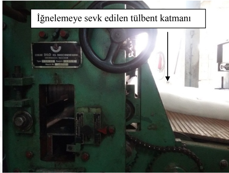
Resim 3.18. Tülbent katmanının iğneleme bölgesine sevk
