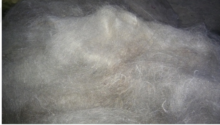
Resim 1.5. Elde edilen kumaş açması geri dönüşüm elyaf
