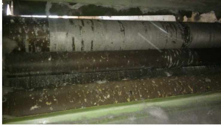
Resim 3.13. Tarama bölgesindeki alıcı-çalıyıcı silindirler
