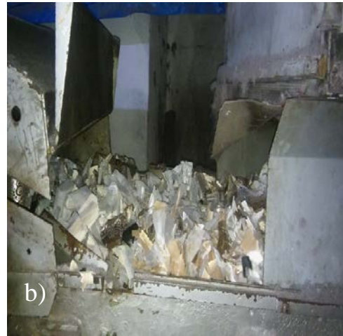
Resim 1.2. a) Kumaş parçalarının açma ünitesine girişi b) Ana tambura geçişi
