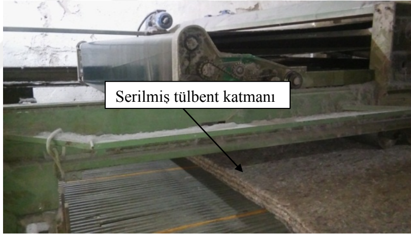
Resim 3.17. Çapraz serim tertibatı ile serilmiş tülbent katmanı
