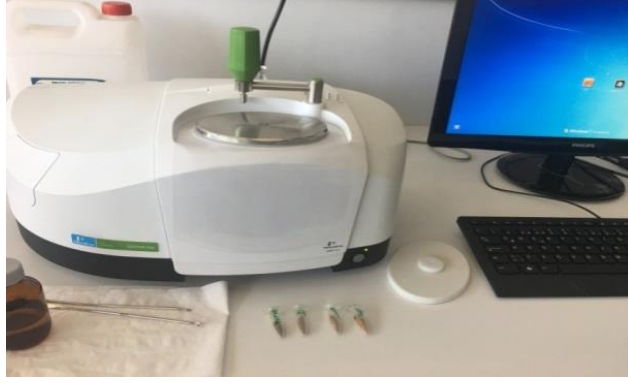
Resim 3.4. Fourier dönüşümlü kızılötesi spektrometre cihazı (FTIR)
