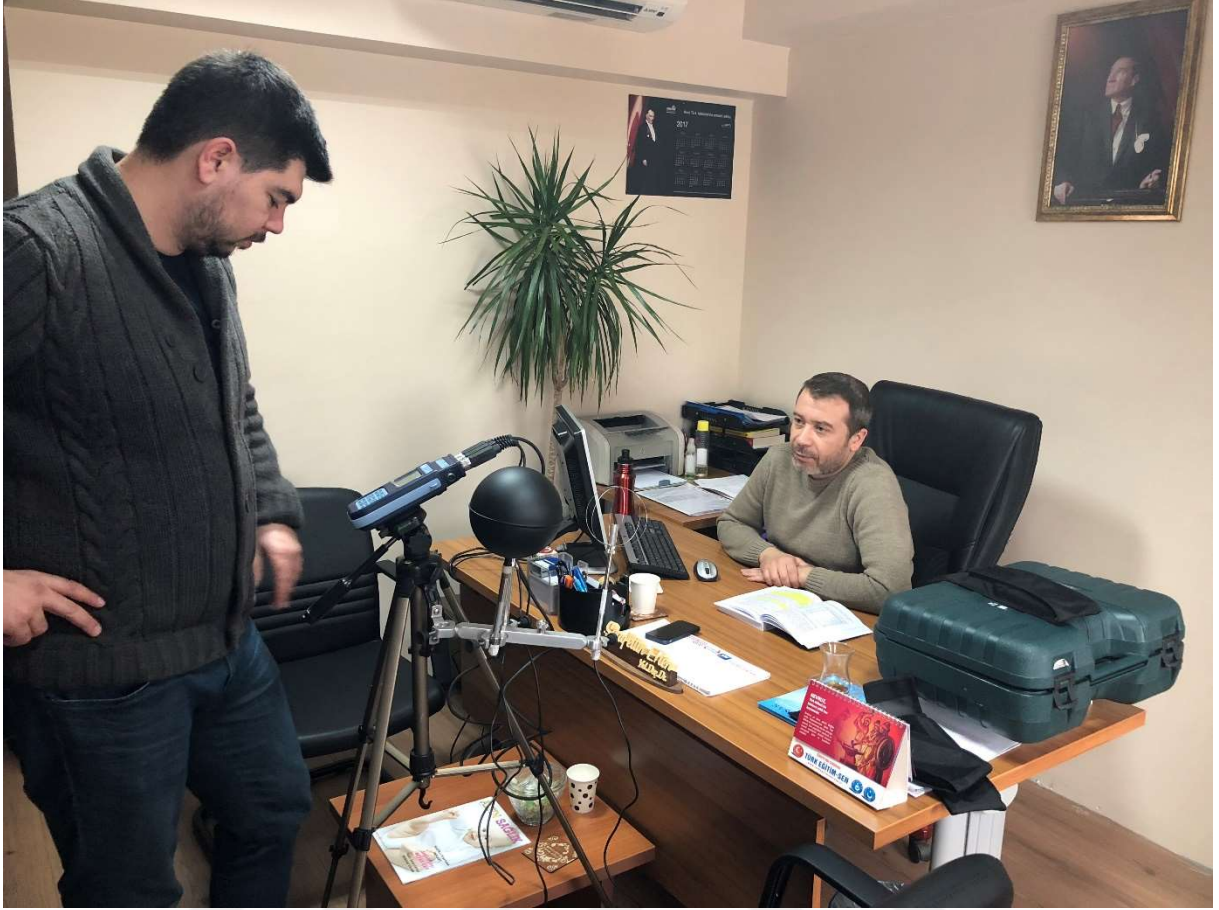
Resim 3. 9. Çalışma Ortamı Termal Konfor Ölçümü 2.
