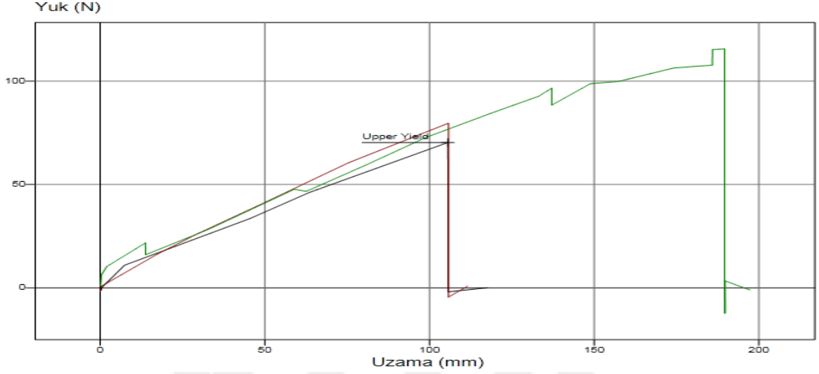
Şekil 96. Püskürtme yöntemi ile üretilmiş çok duvarlı karbon tüp takviyeli EPDM kauçuk çekme test sonucu
