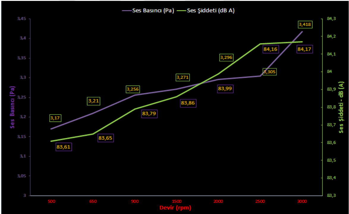
Şekil 127. Püskürtme yöntemi ile nano alümina takviyeli EPDM kauçuk ile üretilmiş krank kasnağı akustik test sonuçları
