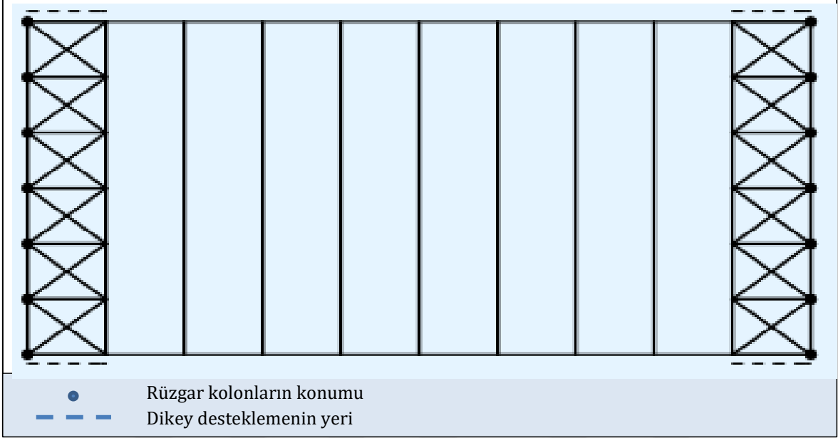
Şekil 2. 46 Çapraz açılı kesitler kullanılarak her iki uç yuvasını gösteren plan görünüşü
