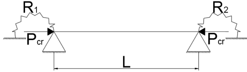
Şekil 3.5. Normal kuvvet etkisi altında dönmeyi engelleyici yaylar ve sabit mesnetler ile mesnetlenmiş kiriş modeli
