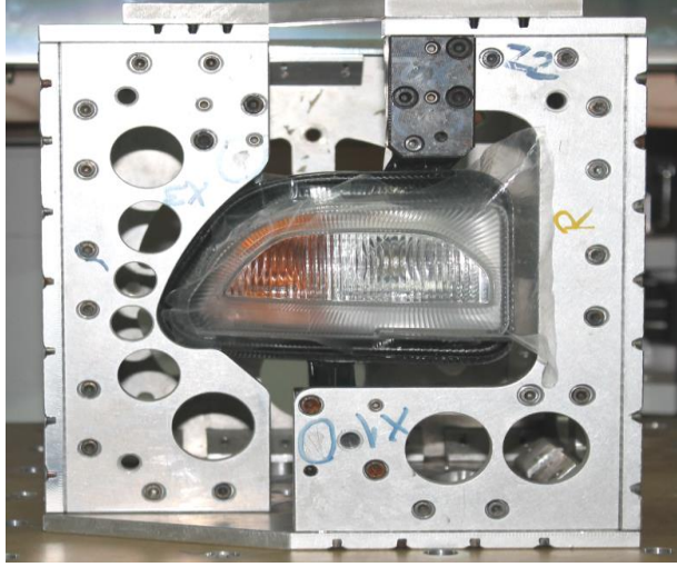
Şekil 4.2 Test Fikstürü ve Gündüz Farı
