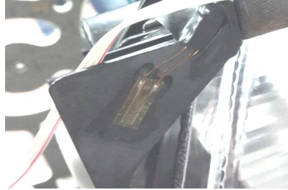
Şekil 4.20 Braket Üzerine Takılmış Birim uzama ölçer
