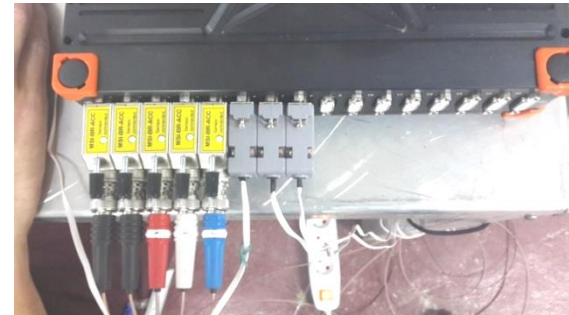
Şekil 4.21 16 Kanallı Veri Toplama Cihazı
