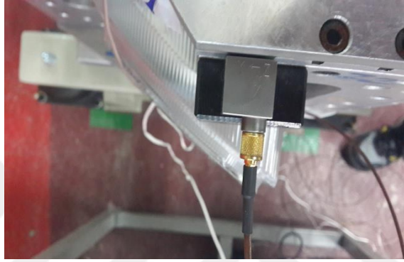
Şekil 4.19 Bağlantı Noktalarına Yakın İvme Ölçer
