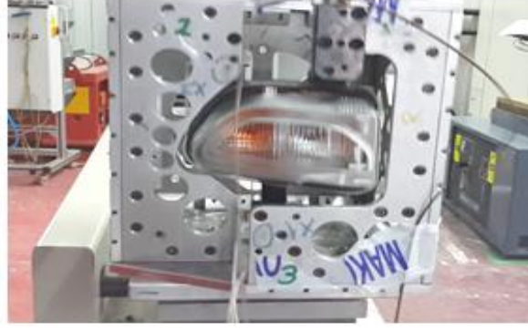
Şekil 4.18 Mekanik Şok Test Makinası, Fikstür ve Gündüz Farı
