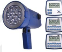
Şekil 3.22 Stroboskop (Anonim 2017f)
