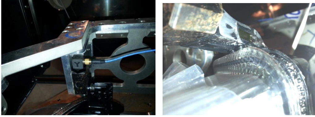
Şekil 4.37 3 Eksenli İvme Ölçer ve Birim Uzama Ölçer Pozisyonları
