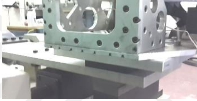
Şekil 4.17 Mekanik Şok Makina Tablası ve Fikstür
