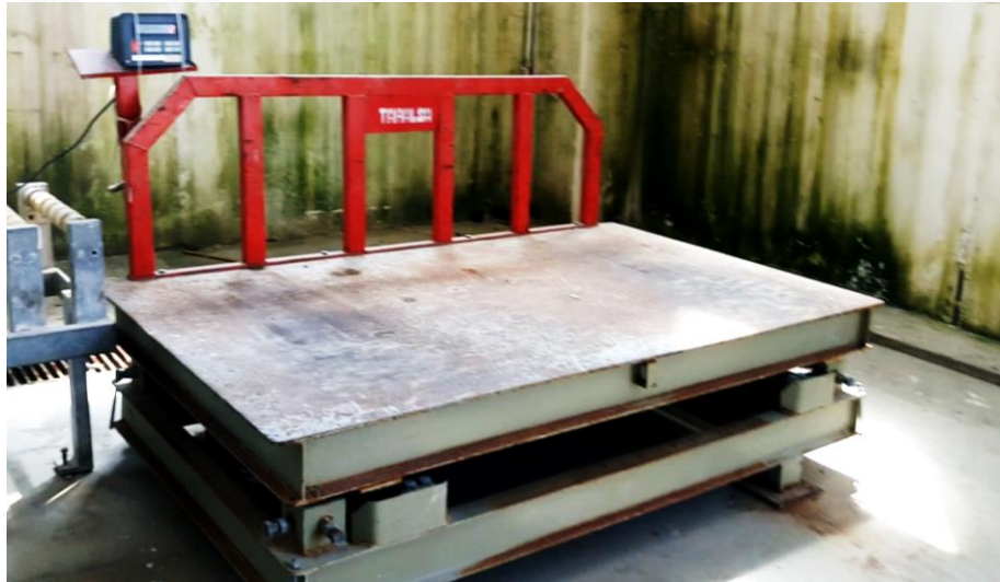
Resim 3. 15. Tesiste kullanılan blok kantarı
