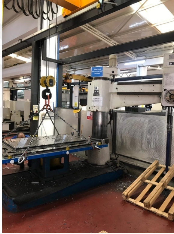
Resim 5.3. Kalıbın caraskal ile taşınması
