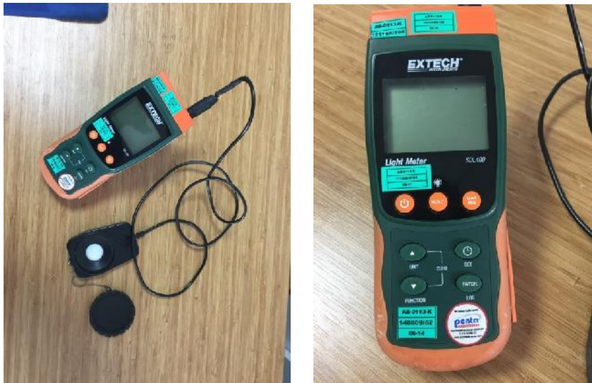
Resim 3.1: Aydınlatma ölçüm cihazı
