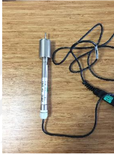
Resim 3.5: Do al ya -hazne sıcaklık ölçüm cihazı
