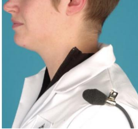
Resim 3.13: Dozimetre (tip 2) cihazı ile ölçüm konumu [18]
