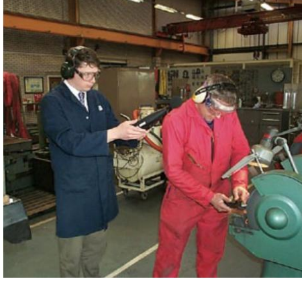
Resim 3.12: El tipi (tip 1) gürültü ölçüm cihazı ile ölçüm konumu [18]
