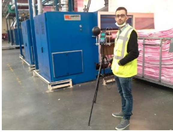
Resim 3.3: Tekstil sektöründe termal konfor ölçümü
