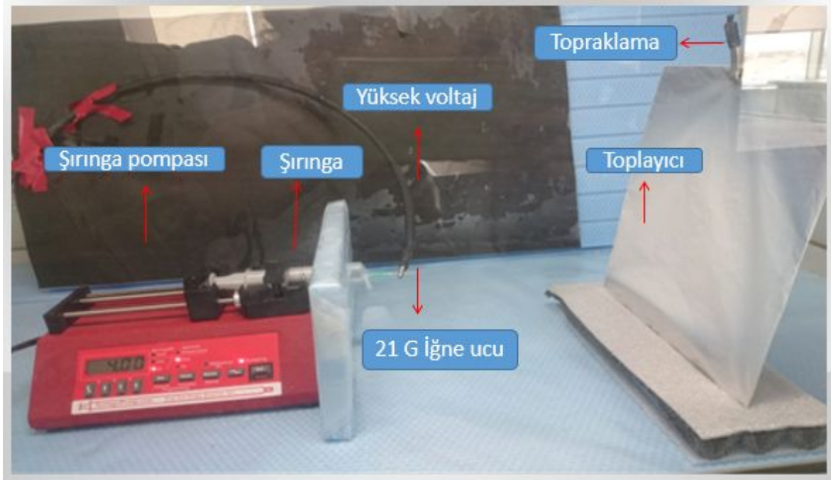
Resim 5.3. Uçak Üniversitesi Malzeme Bilimi ve Nanoteknoloji Mühendisliği Bölümü Laboratuvarı'nda bulunan elektrolif çekim düzeni
