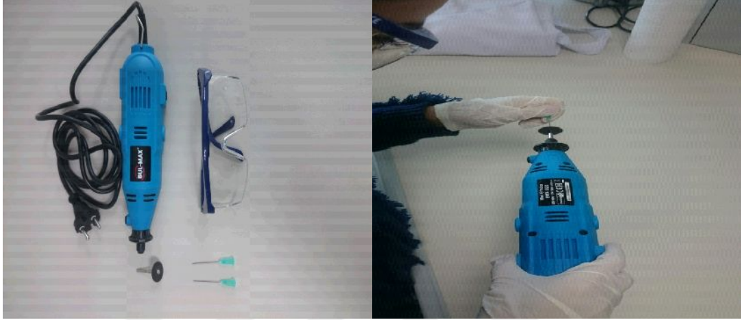
Resim 5.2. İğnelerin uçlarının kesilerek elektrolif çekimi için hazırlanması
