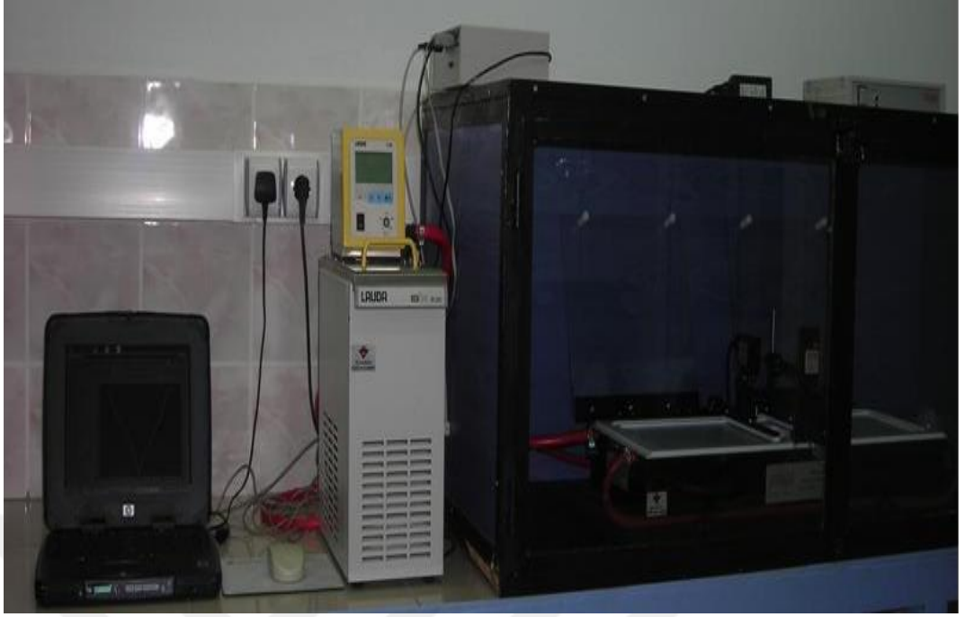
Şekil 2.3.3. Çift vagonlu Nima 622 model alternatör layer LB teknesi
