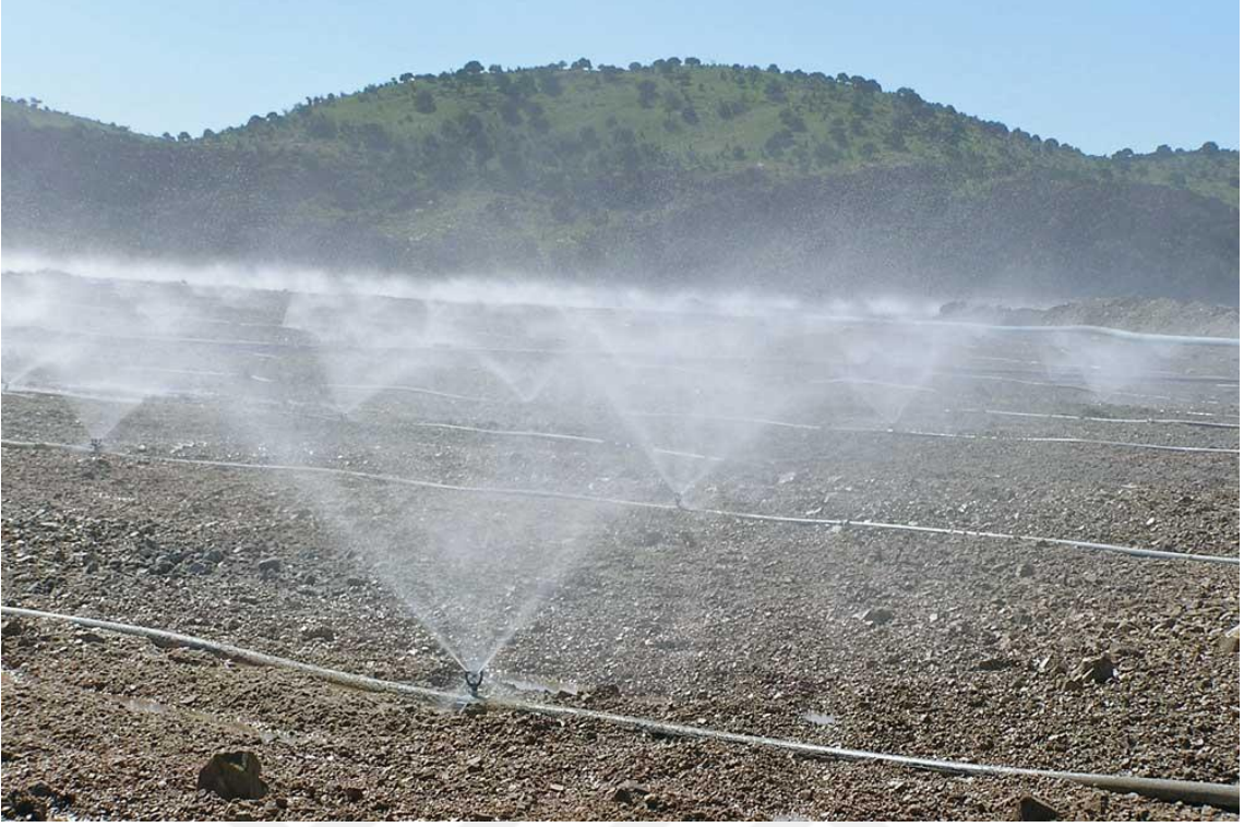
Resim 3.12 Yağmurlama liç yöntemi
