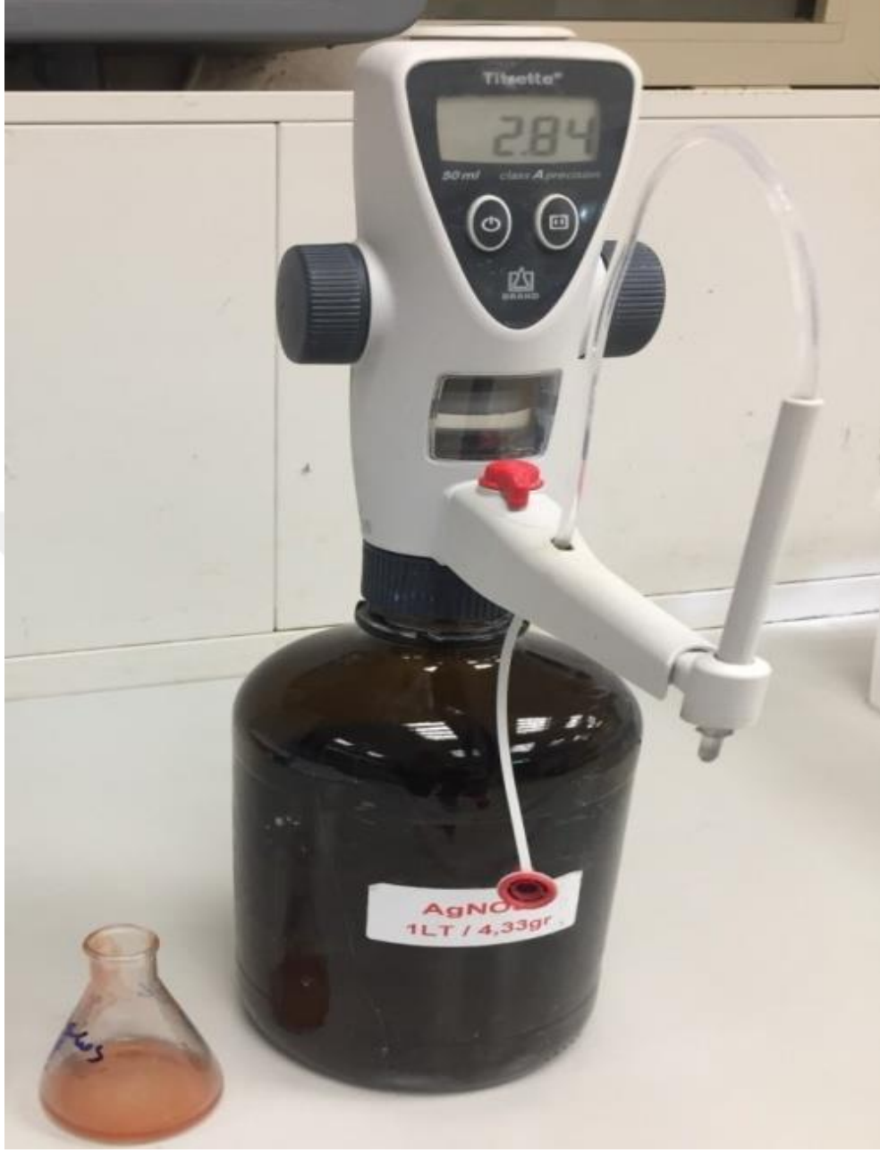
Resim 4.4 CN ölçümlerinde kullanılan \text{AgNO}_3 titrasyonu düzeneği
