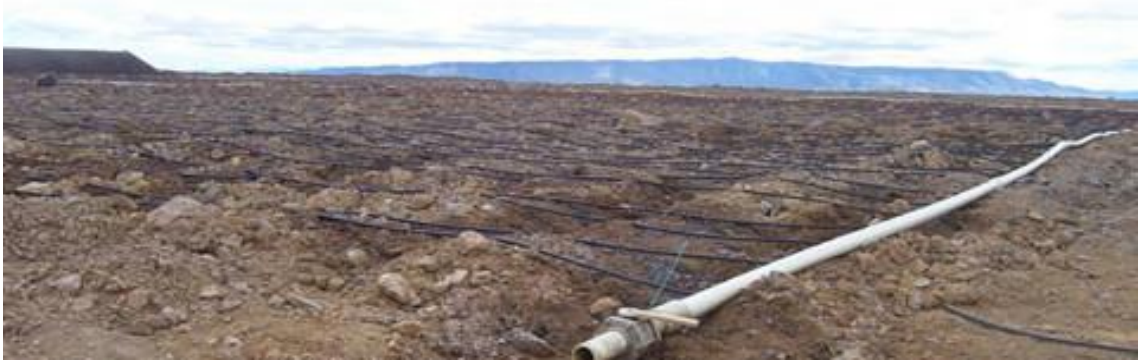
Resim 3.11 Yüzeyden damlatma liç yöntemi
