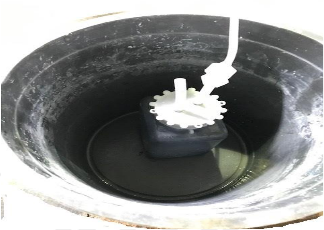
Resim 4.2 Çözünmüş altının aktif karbon üzerine yüklenmesi
