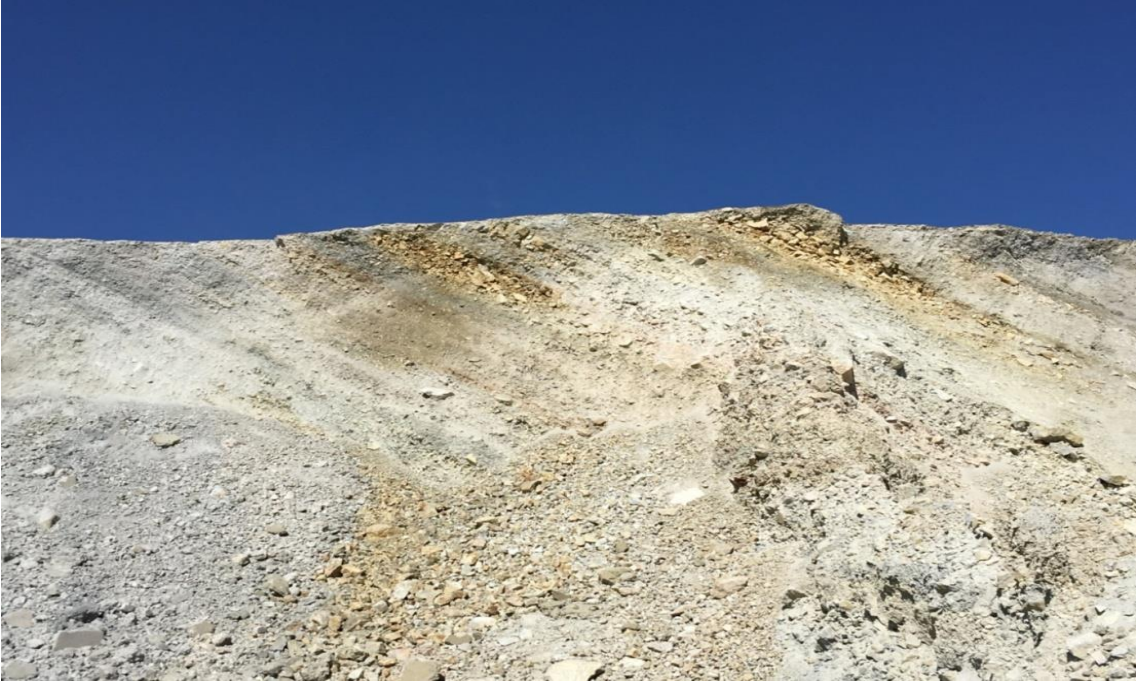
Resim 3.3 Kamyon ile yığınlamada segregasyon
