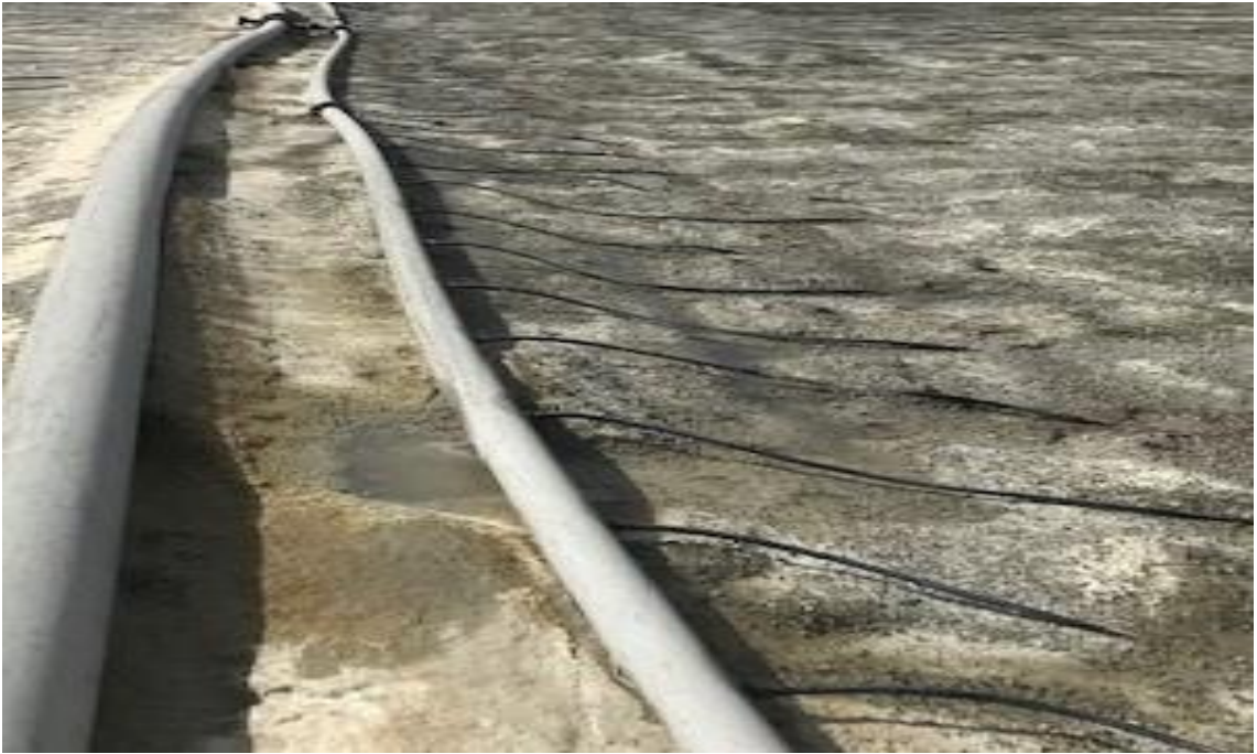
Resim 3.10 Gömülmüş damlatma tipi liç yöntemi
