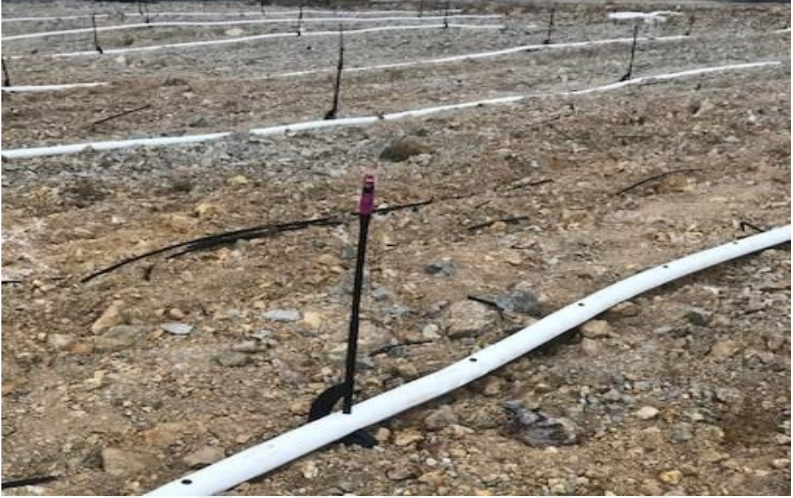
Resim 3.9 Yağmurlama tipi liç yöntemi
