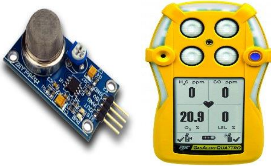
Sekil 3.1.2. H 2 S, CO ve O 2 ortam gaz ölçüm cihazı
