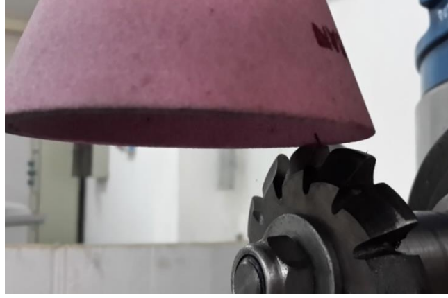
Resim 6.2. Taşlama yardımıyla kesici takıma hata verilmesi
