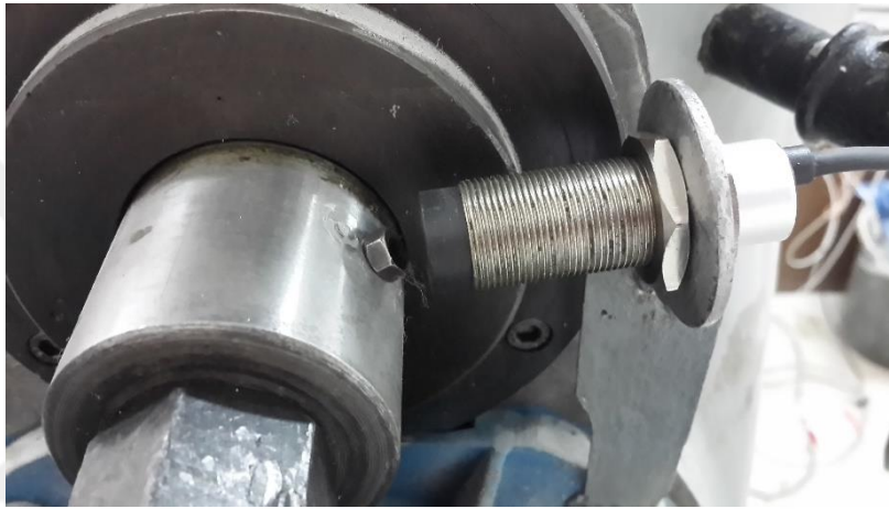
Resim 4.4. Kesici takım konumunu belirten sensör
