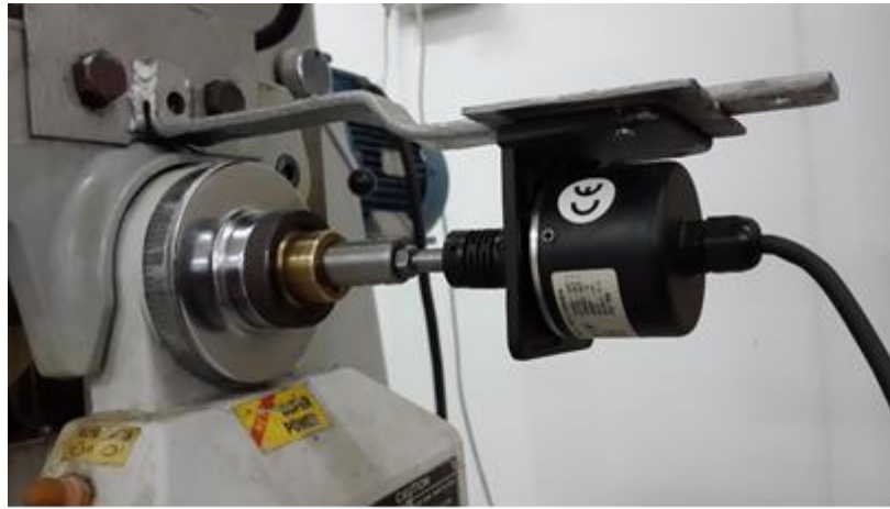
Resim 4.3. Tabla hızı ölçümü için kullanılan enkoder
