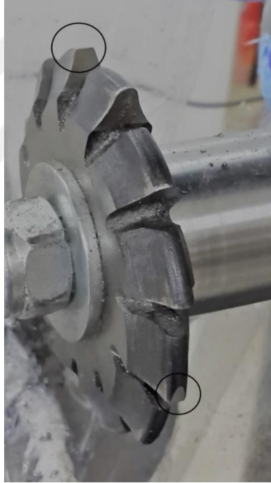
Resim 6.1. Kesici takıma uygulanan diş hataları
