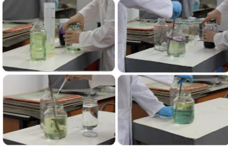
Resim 3.4. Polyester reçinenin hazırlanışı
