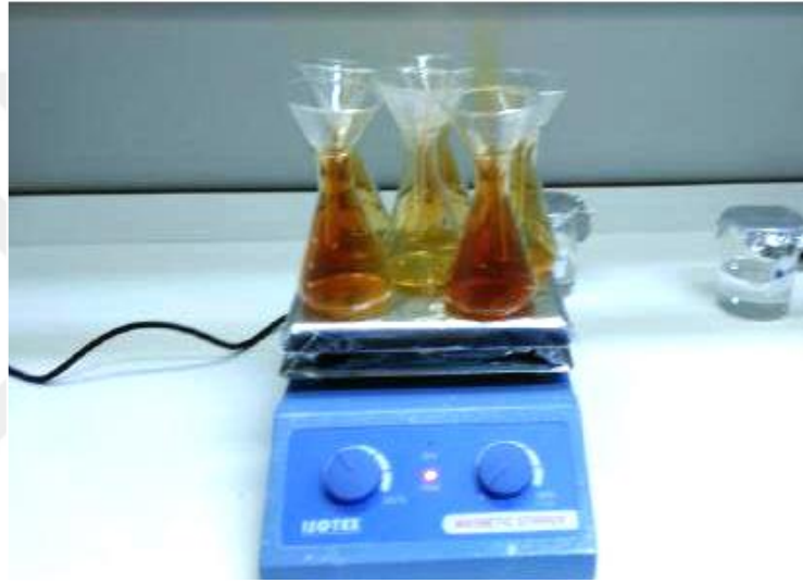
Resim 4.3. Isıtıcı tablada asit ile yaş yakma metodu
