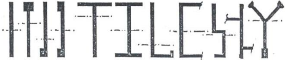
Şekil 3.5. Perde Kesit Şekilleri [4]
