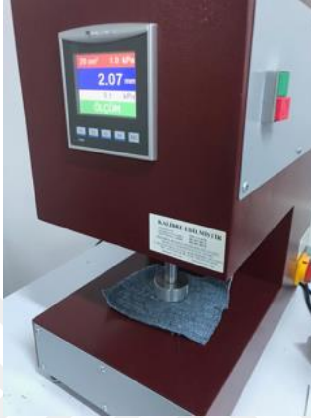
Resim 3.8. Unitronics kalınlık ölçüm cihazında battaniye numunesinin ölçümü
