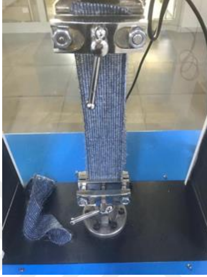
Resim 3.12. UTEST çekme test cihazında battaniye numunesinin ölçümü
