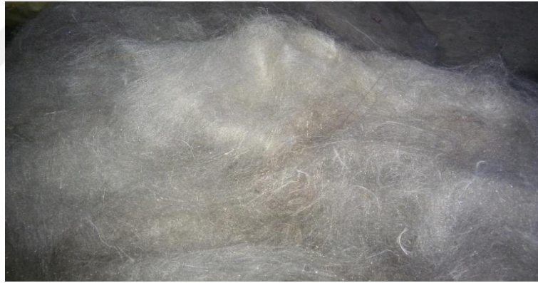
Resim 1.2. Mekanik yolla açılarak elde edilmiş geri dönüşüm lifler
