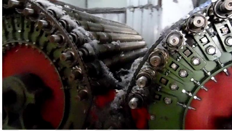
Resim 1.1. Mekanik açmada tamburların etrafındaki silindir çiftleri
