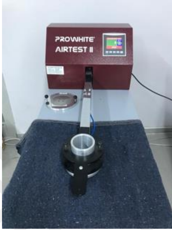
Resim 3.10. Prowhite Airtest II hava geçirgenliği ölçüm cihazında battaniye numunesinin ölçümü
