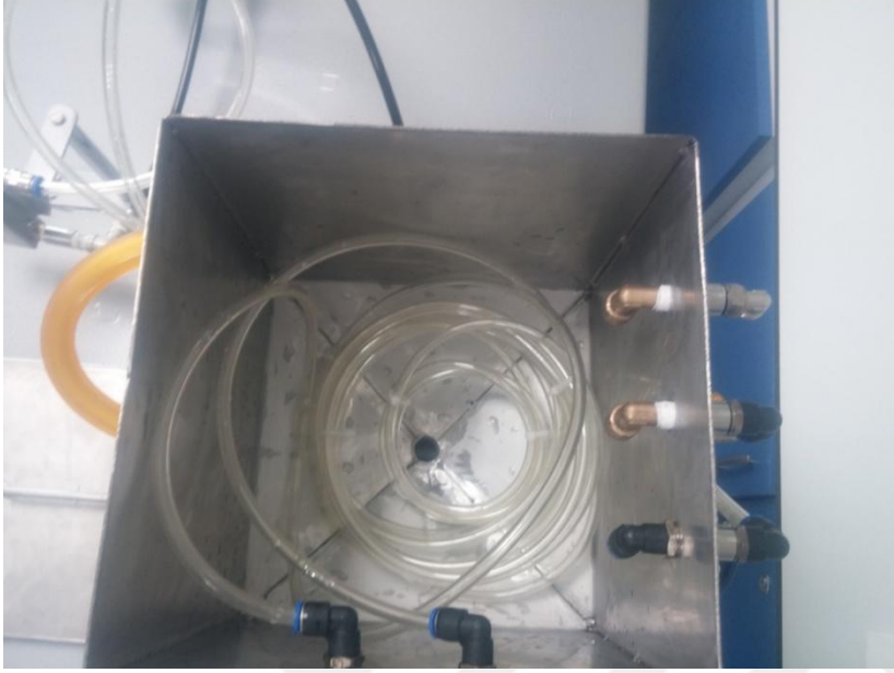
Şekil 3.8 Besleme kazanının içindeki şeffaf borudan hazırlanmış soğutma sistemi
