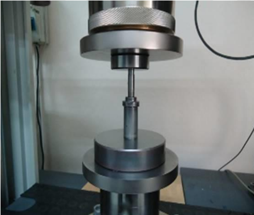
Resim 6.14. Mandrel ve pres ile delik çapı genişletilmesi
