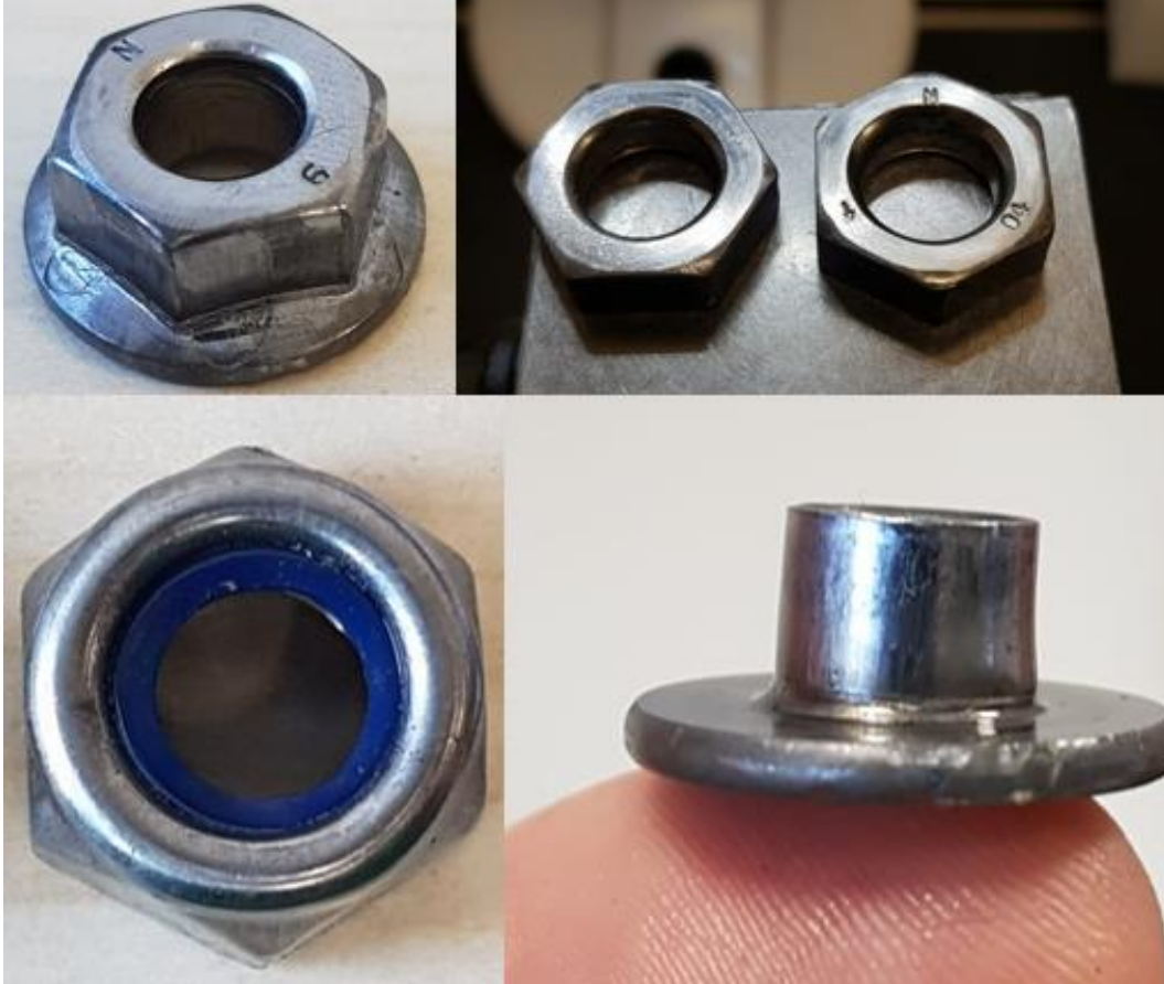
Resim 6.1. Üretim kaynaklı hatalar
