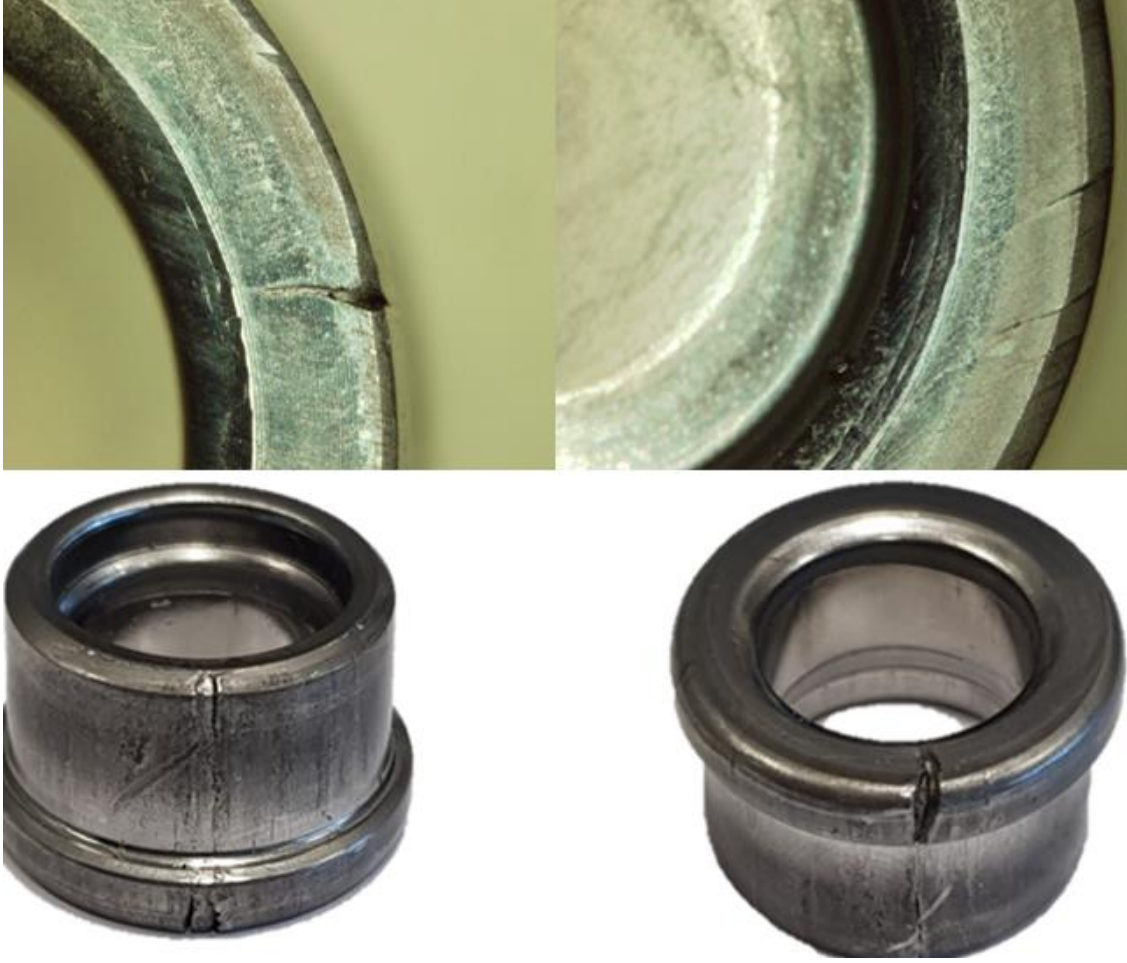
Resim 6.19. SAE 1006 (1.0313) çeliği ile üretilen burçlarda oluşan çatlaklar
