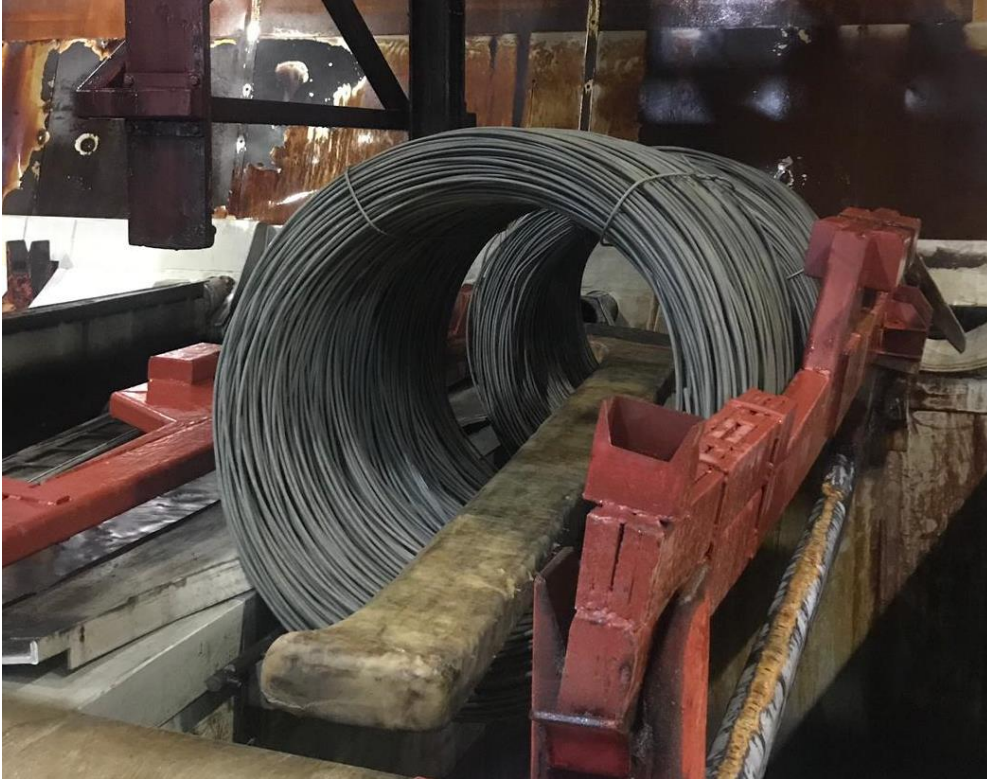
Resim 4.2. Kimyasal yüzey işlem yapılan hammadde
