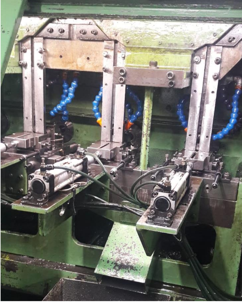
Resim 4.6 Diş açma makinesi çalışma mekanizması
