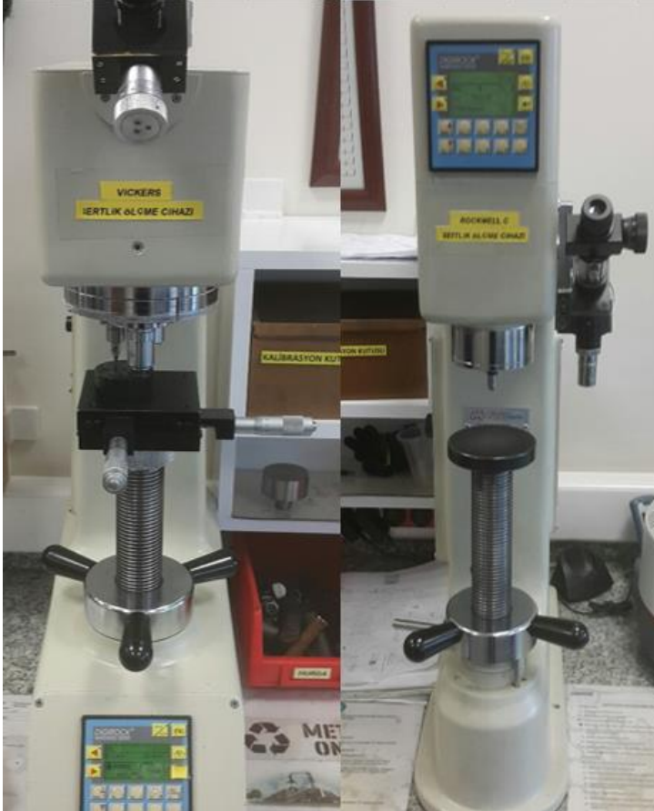
Resim 5.6. Vickers ve rockwell sertlik ölçme cihazları
