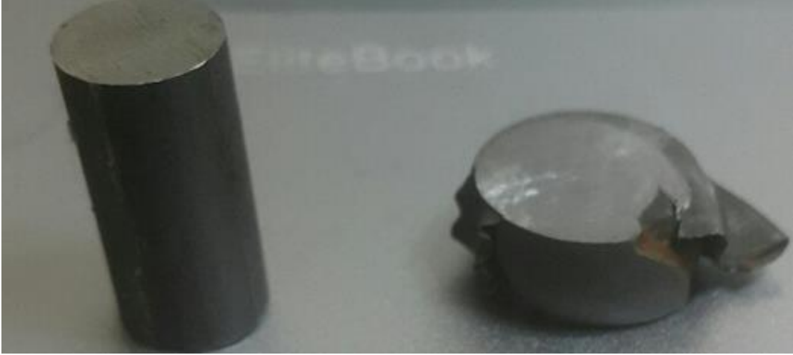
Resim 6.17. Ø12 23MnB4 (1.5535) ezme testi numunesi ve ezildikten sonra çatlak oluşumu
