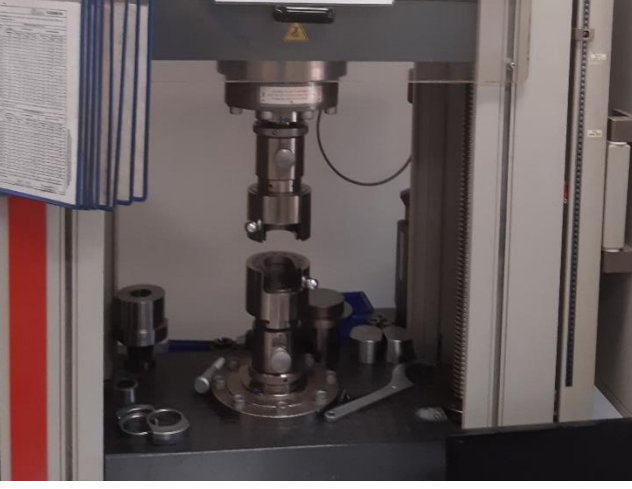
Resim 5.8. Zwick/Roel Z250 çekme cihazı
