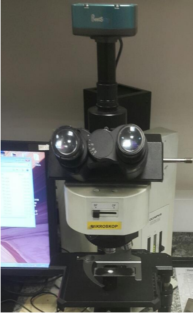
Resim 5.7. Olympus marka metal mikroskobu ve bestScops marka kamera
