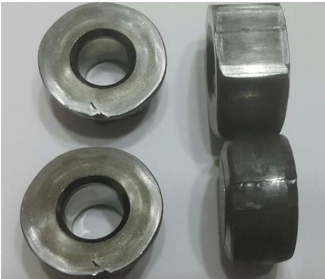
Resim 6.10. Soğuk dövme sırasında çatlak hasarı oluşmuş numuneler
