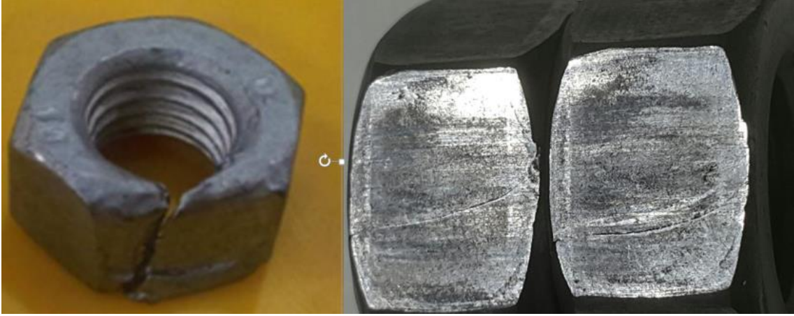
Resim 6.2. Soğuk dövme çatlakları
