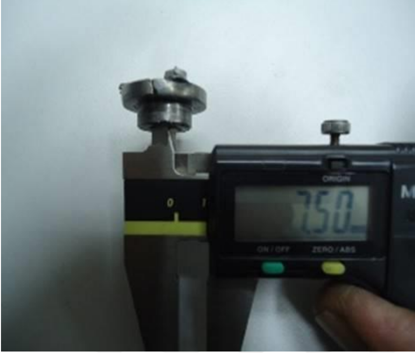
Resim 6.13. Test öncesi delik çapı nominale getirilmiş somun
