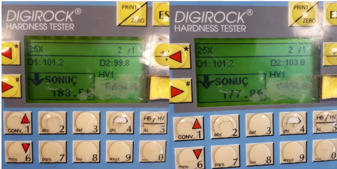
Resim 5.5 Vickers sertlik deneyinde numuneden alınan ölçümler ve vickers sertlik deneyi cihazının formül ile doğrulanması için cihazdan alınan sertlik deneylerinin sonuçları.
