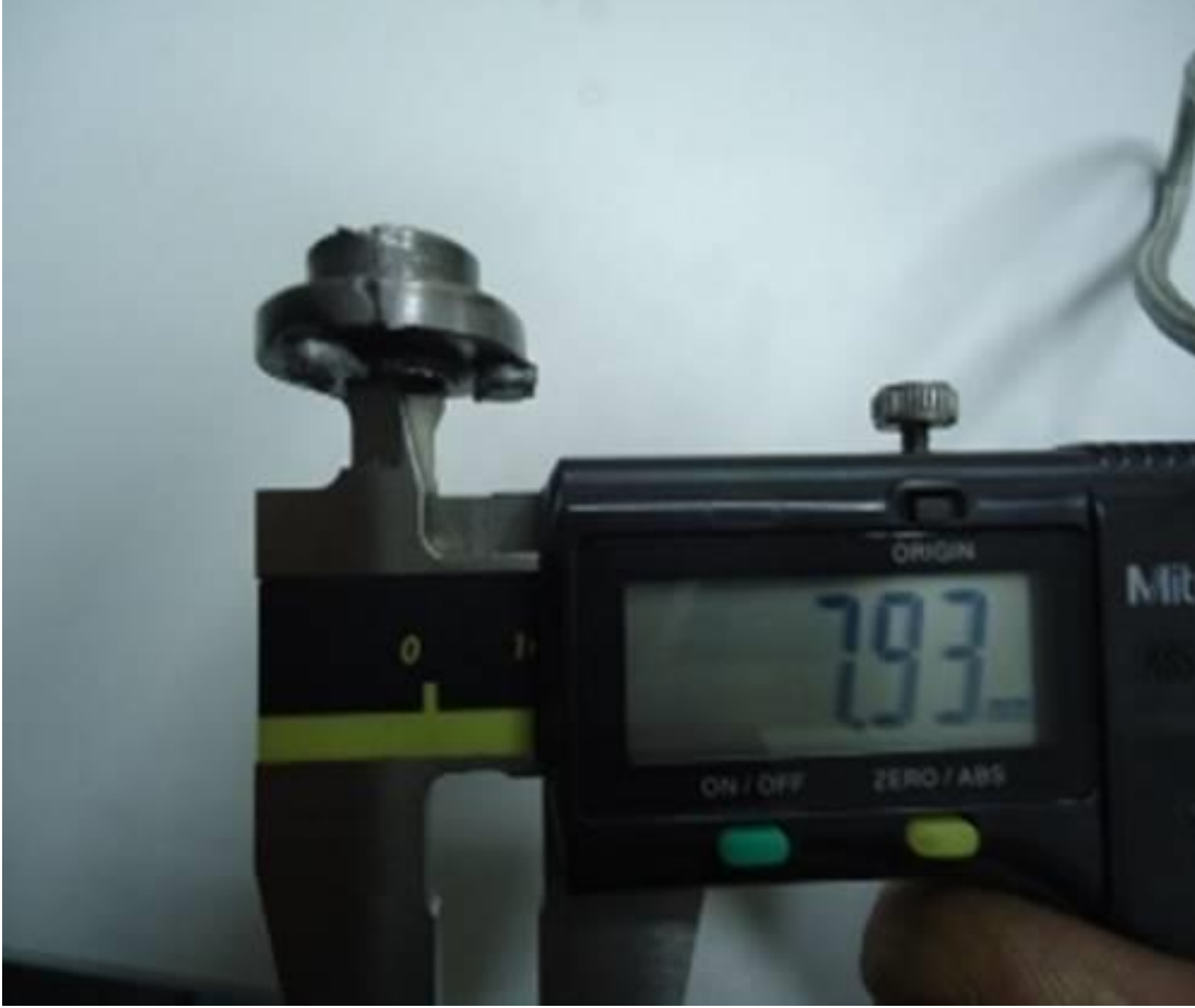
Resim 6.15. Genişletme testi sonrası somun delik çapı
