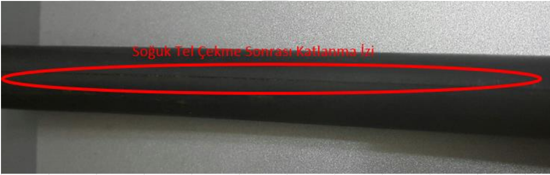
Resim 6.18. Ø12 23 MnB4 (1.5535) hammadde yüzeyinde boyuna katlanma izi
