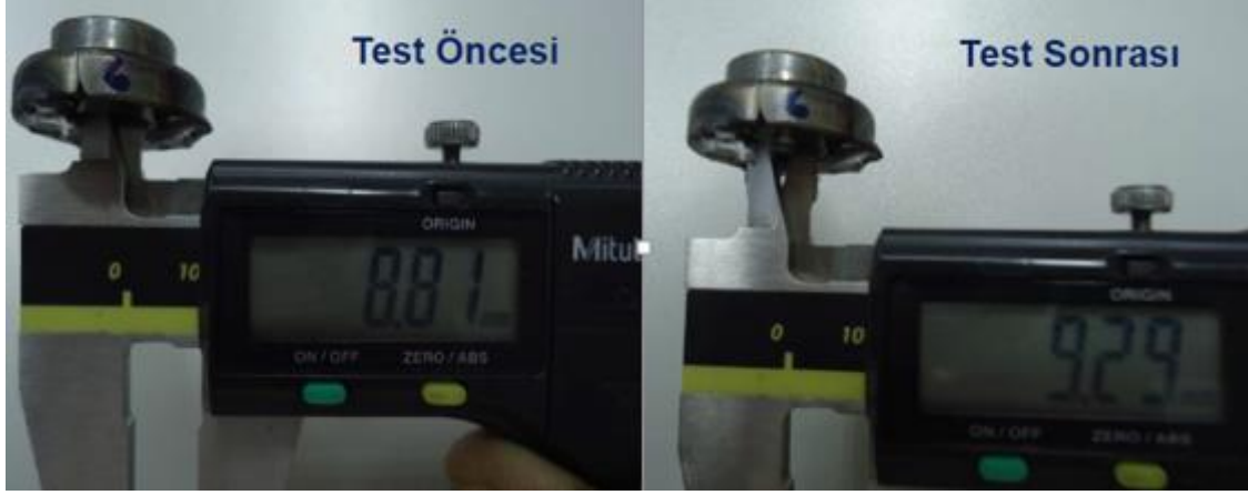
Resim 6.16. M10x1,25 yuvarlak kaynak somununa yapılan genişletme testi
