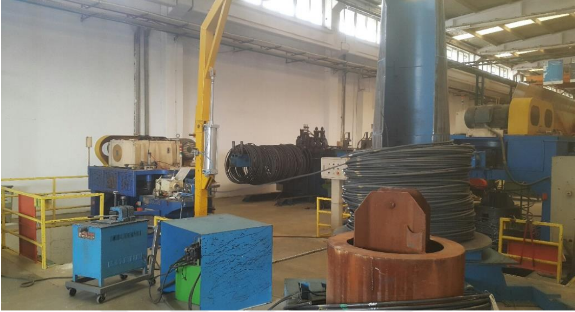
Resim 4.3. Soğuk tel çekme makinesi
