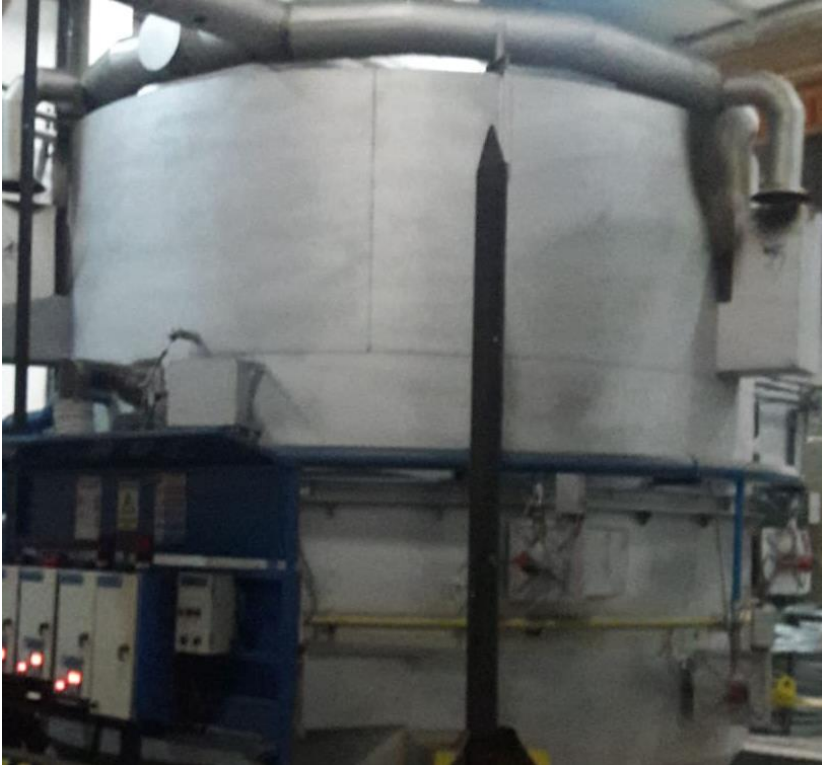
Resim 4.1. Hammadde tavlama fırını
