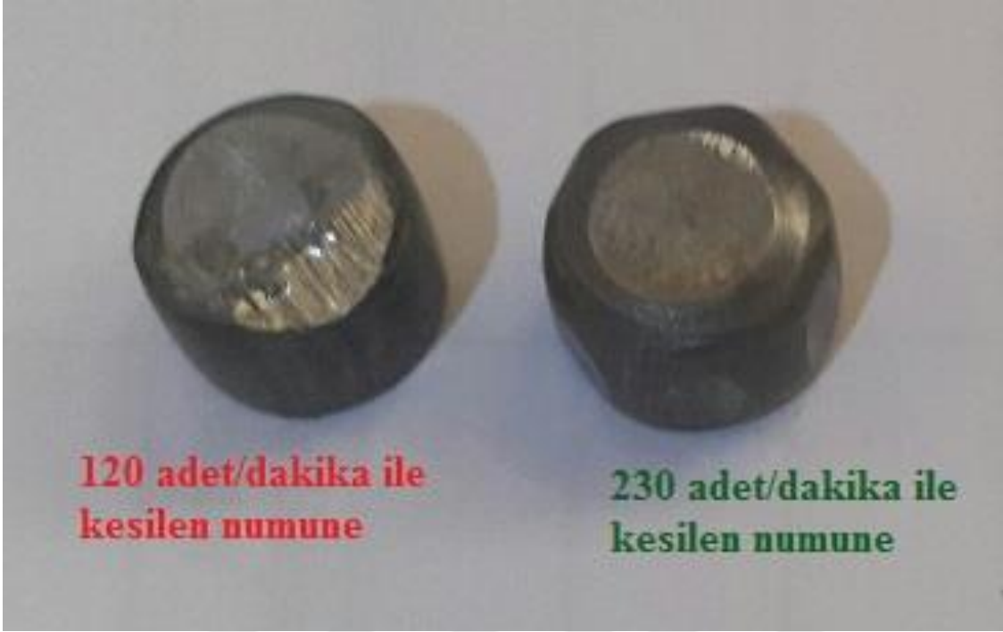
Resim 6.6. Ø9 17MnB3 (1.5520) çeliğinden düşük ve yüksek hızda kesilen numunelerin ilk istasyonda dövüldükten sonraki görselleri
