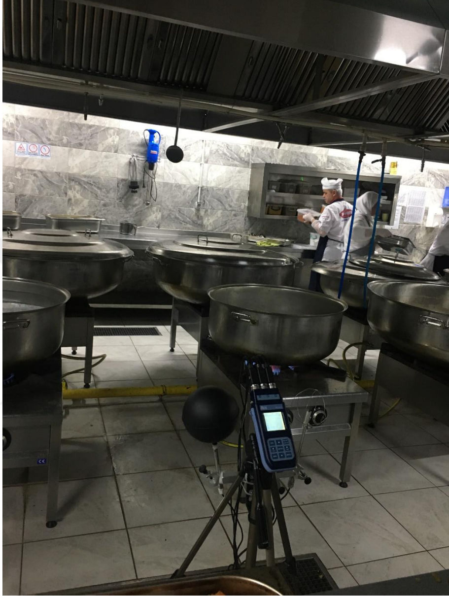
Resim3.8. Mutfak ocak-fırın önü termal konfor ölçümü
