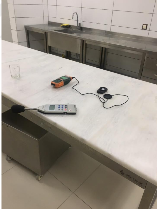
Resim 3.6. Mutfak pastane bölümünde gürültü ve aydınlatma şiddeti ölçümü
