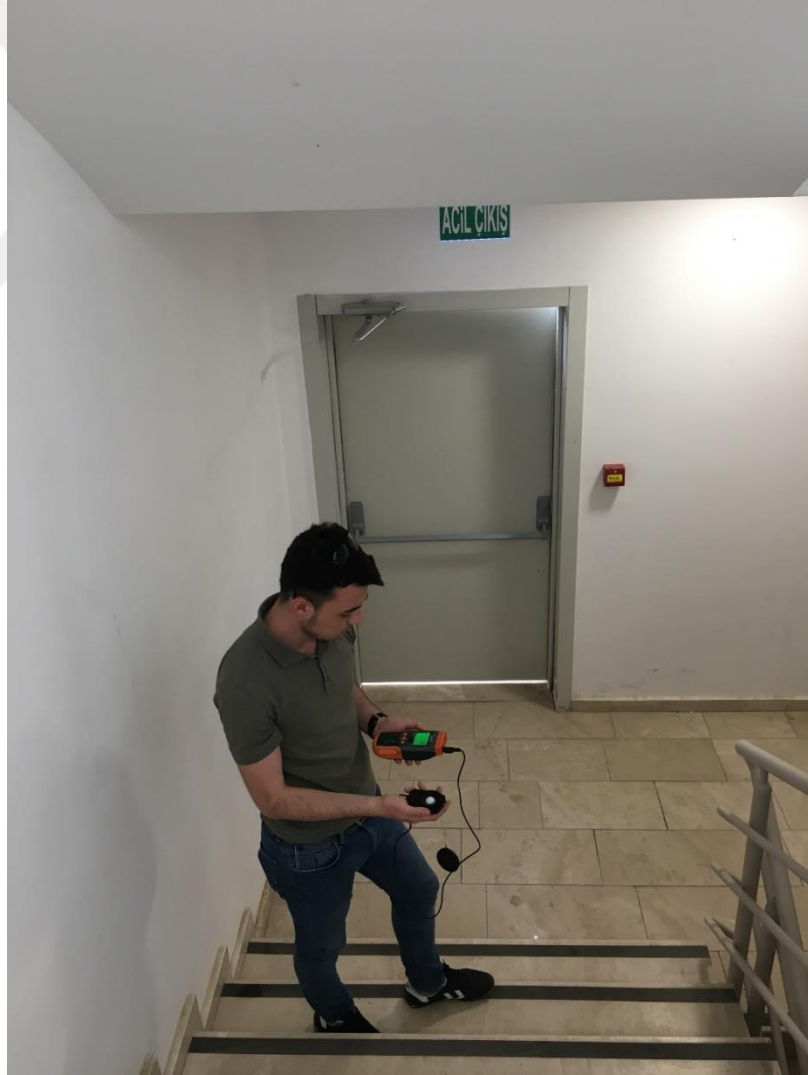
Resim 3.4. Acil kaçış merdiveni aydınlatma şiddeti ölçümü
