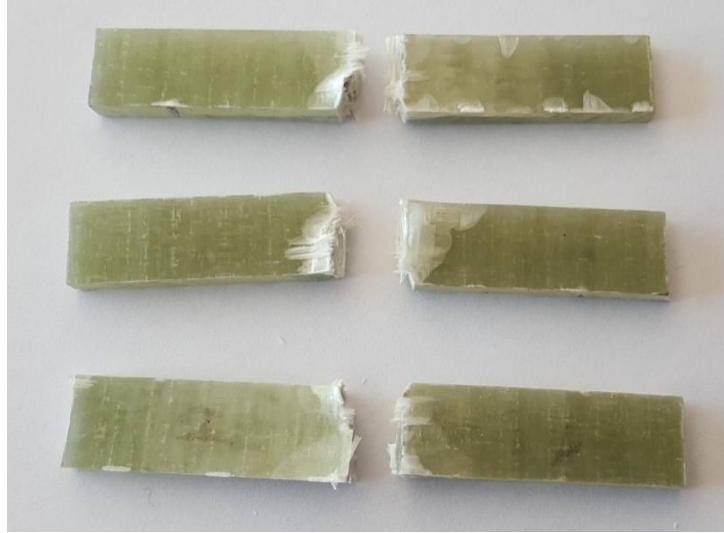
Resim 4-16 Çentik darbe testi sonucunda hasara uğramış kompozit numuneler
