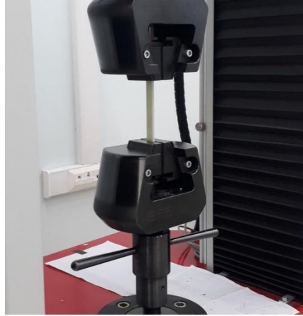
Resim 4-8 Çekme numunesinin çekme testi cihazında çenelerde bağlanmış görünümü
