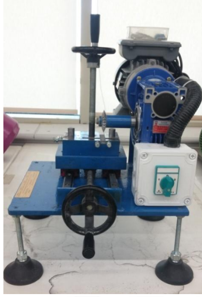
Resim 4-13 Çentik açma cihazı
