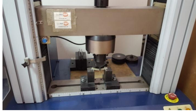
Resim 4-11 Üç nokta eğilme deneyi numunesinin eğilmeye zorlanması
