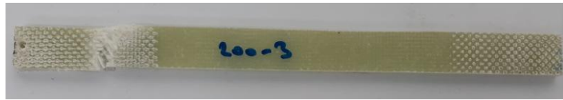
Resim 5.9. Çekme deneyi sonrasında numunenin görüntüsü
