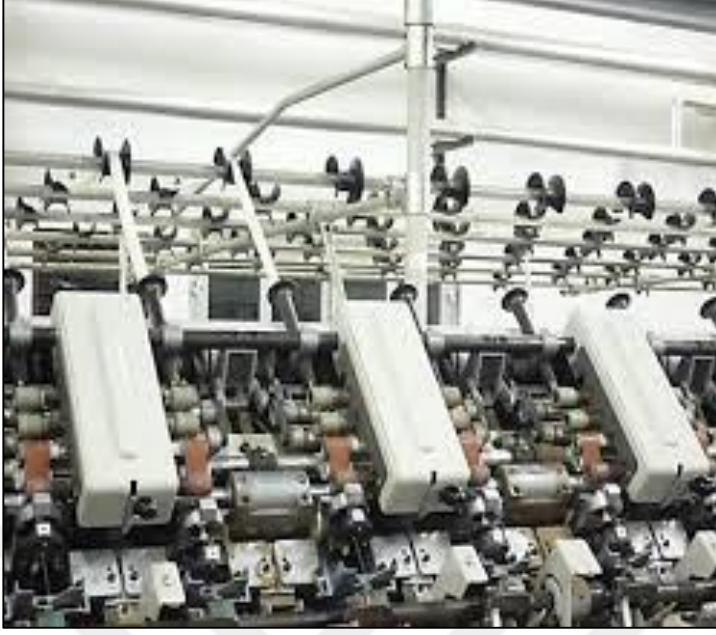
Şekil 2. 22 MVS 810 Üzerinde Vortex İplik Üretimlerinin Gösterimi
