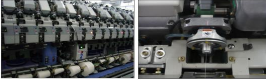
Şekil 2. 22 MVS 810 Üzerinde Vortex İplik Üretimlerinin Gösterimi
