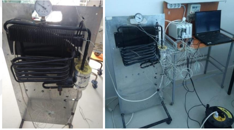
Resim 3.1. 1. Bir Difüzyon Absorpsiyon Soğutma Sisteminin Şematik Bir Görünümü
