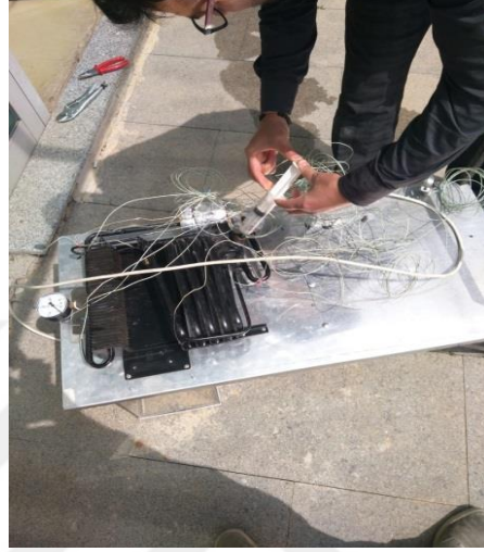
Resim 3.2. 2. TiO 2 Karışımın Yapılması ve Deney Setine Şarj Edilmesi
