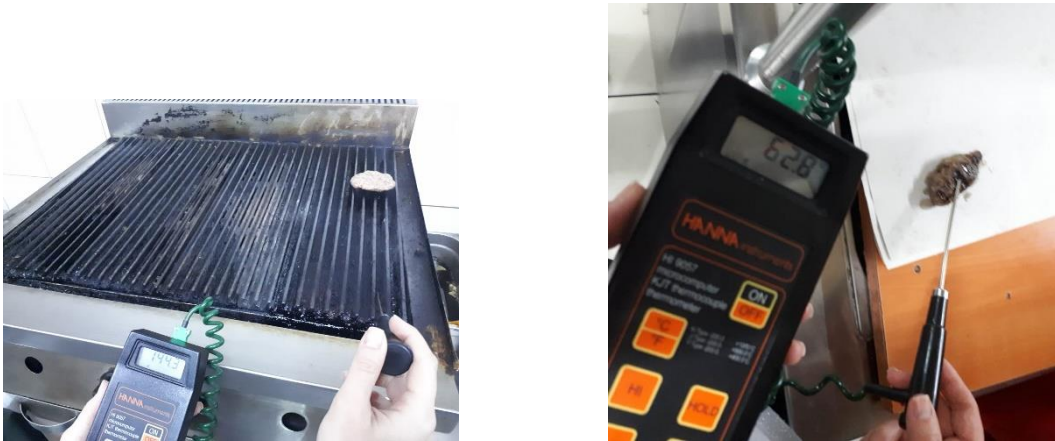
Şekil 3.2. Köfte işletmelerinde ızgara yüzey sıcaklığı (sol) ile köfte merkez sıcaklığının (sağ) belirlenmesi
