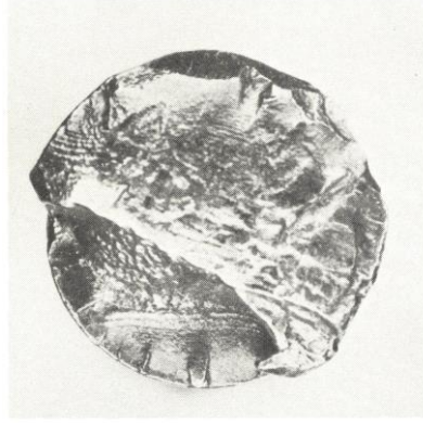
Resim 3.8. Supap sapı yorulma hasarı [22]
