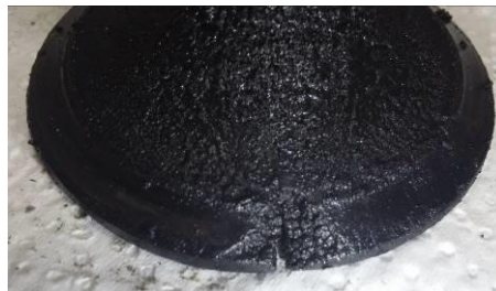
Resim 3.5. Supap oturma yüzeyi distorsiyonu nedeniyle yanma hasarı
