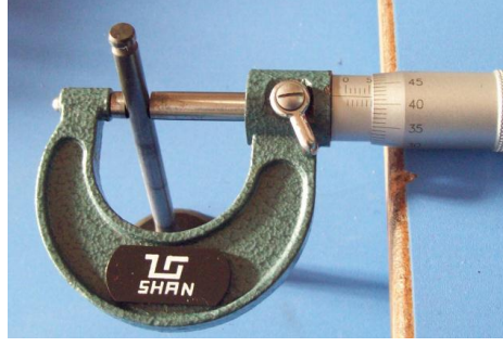
Resim 3.2. Mikrometre ile çap ölçümü [10]
