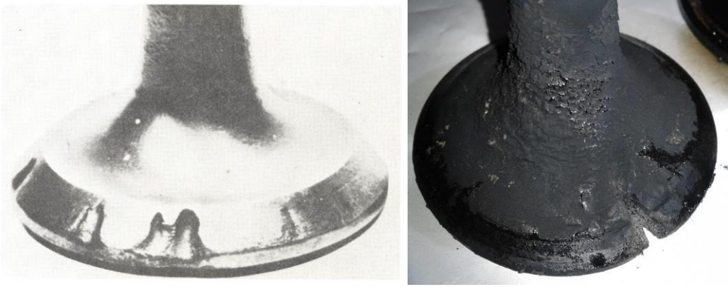
Resim 3.7. Karbon birikintileri nedeniyle supapta oluklaşma [22]
