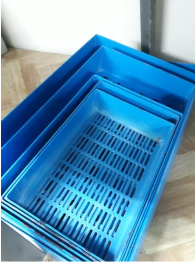
Şekil 8.5. Yassılık indeksi elekleri ve şablonu
