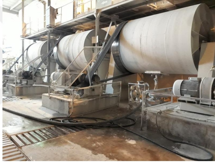
Şekil 4.6. Sır hazırlama değirmenleri
