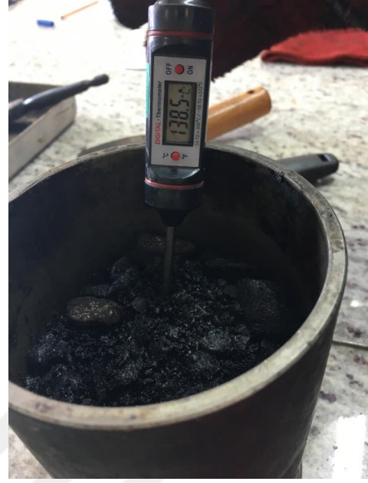
Şekil 8.22. Elle karıştırma, briket kalıbına yerleştirme ve ilk sıcaklık ölçümü
