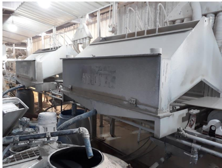
Şekil 4.6. Sır hazırlama değirmenleri
