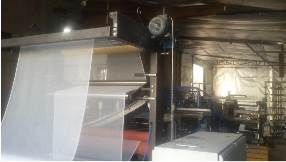
Resim 6.2. Gazlı bezin ilk silindirlere geçişi
