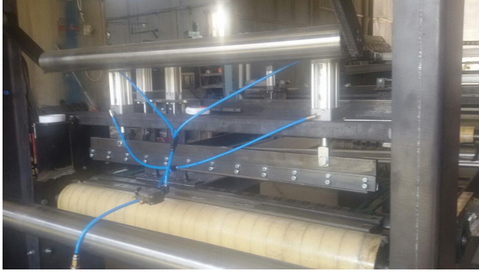
Resim 6.6. Giriş kısmı ve kesme tertibatına pistonların montajı
