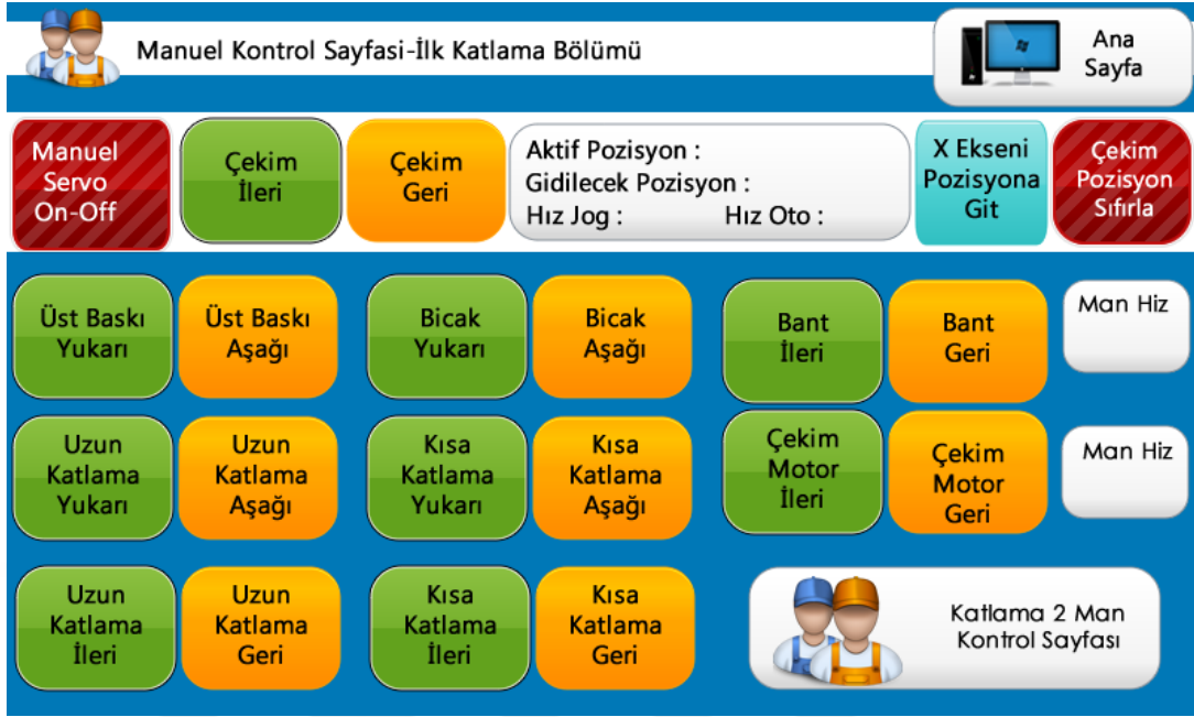
Resim 7.3. İlk katlama bölümü kontrol sayfası otomasyon ekran görüntüsü
