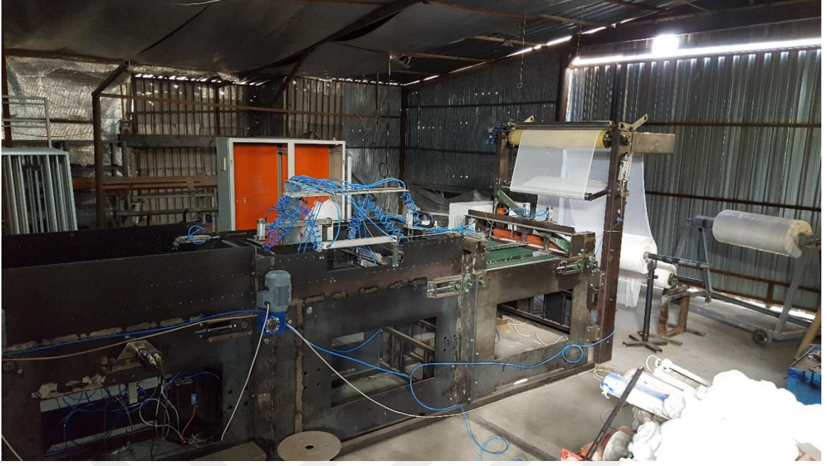
Resim 6.19. Tasarımı ve imalatı yapılan makinenin kesme ve katlama kısmının genel görünüşü
