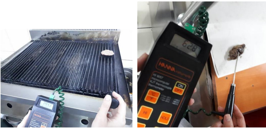
Şekil 3.3 Köfte İşletmelerinde Izgara Yüzey Sıcaklığı(sol) ile Köfte Merkez Sıcaklığının(sağ) Belirlenmesi
