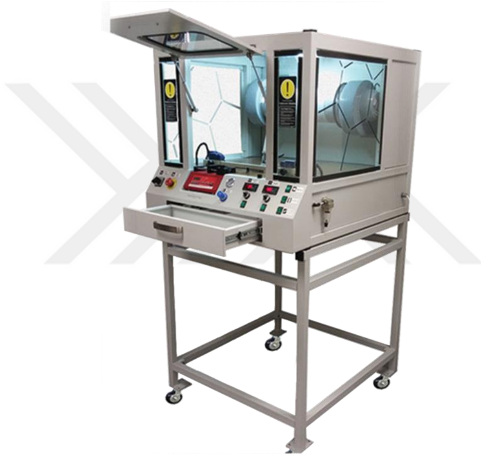
Resim 3.2.2.1. Aerospinner (laboratuvar ölçekli çözelti üfleme)
