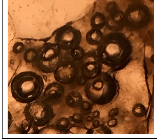
Resim 2.13 M1 kodlu kompleks koaservattan elde edilen mikrokapsüller
