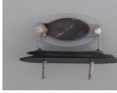
Resim 3.3 Üzerine LB film transferi yapılan kuartz kristali
