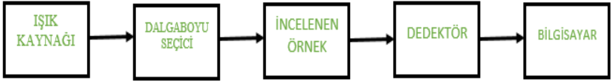
Şekil 2.15 Bir spektrofotometrenin temel bileşenleri
