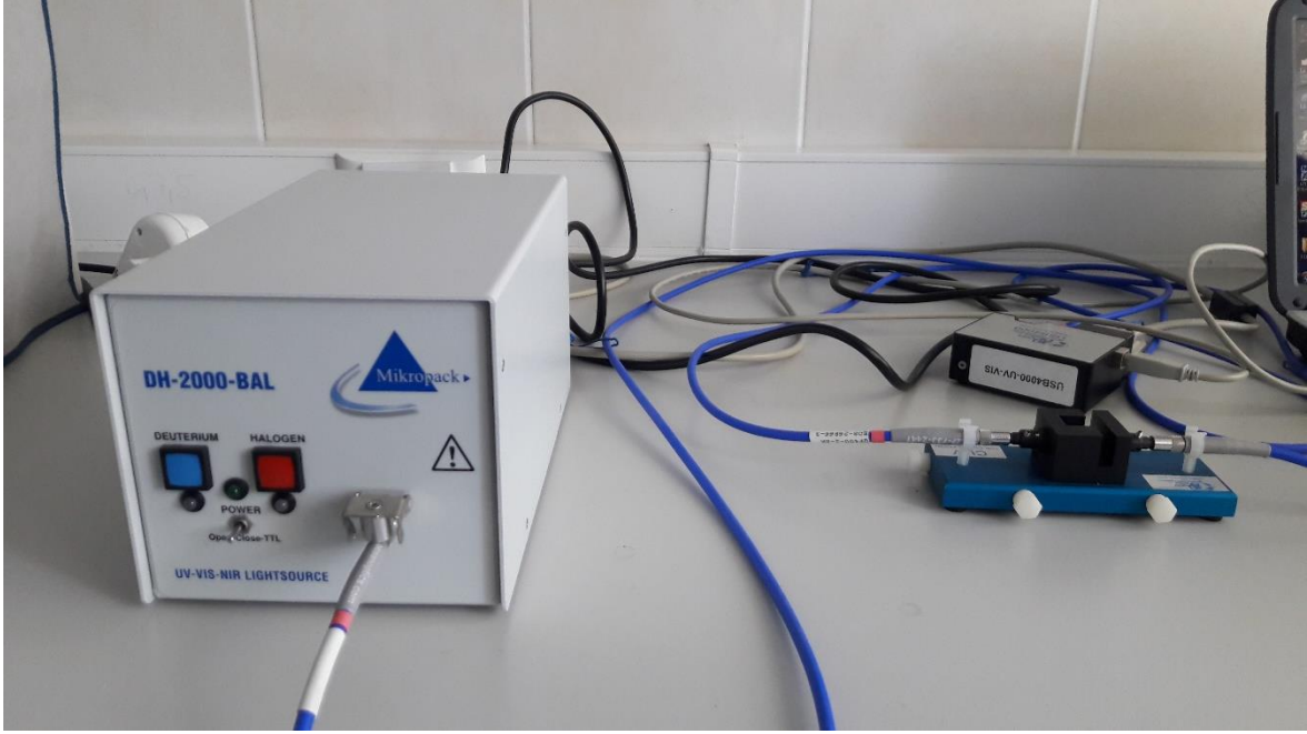
Resim 3.2 LB film karakterizasyonu için kullanılan UV görünür bölge spektrofotometresi
