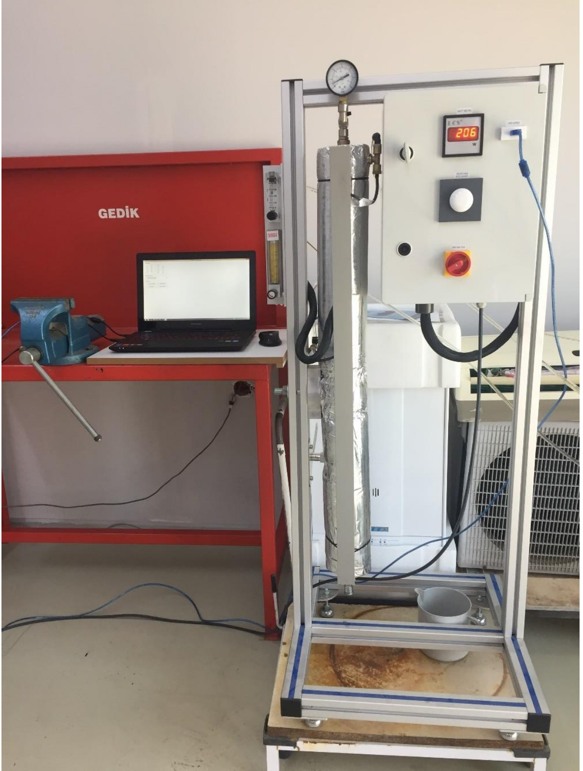
Resim 4. 2. Termosifon ısı borusu deney düzeneđi
