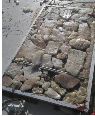
Resim 6.3 Parafin kullanılan PVT sistemin iç yapısı [40]
