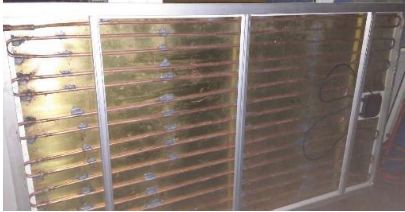
Resim 6.2 Deney düzeneğinde kullanılan akışkan dolaşım kanalları [40]
