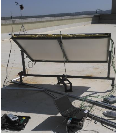
Resim 6.5 Deney düzeneğinde kullanılan kasa ve taşıma ayakları [40]
