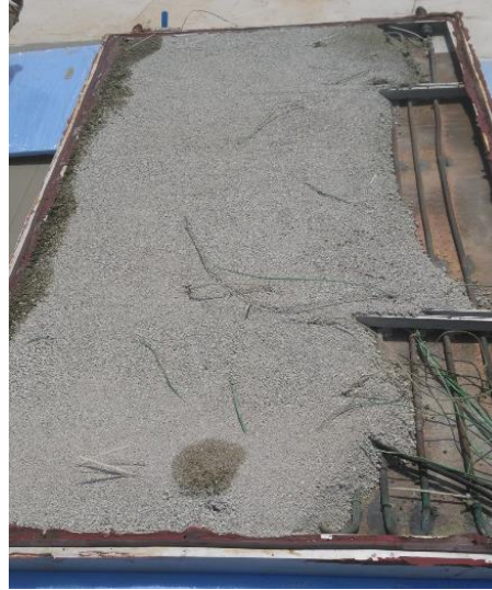
Resim 6.4 Zeolit kullanılan PVT sistemin iç yapısı [40]
