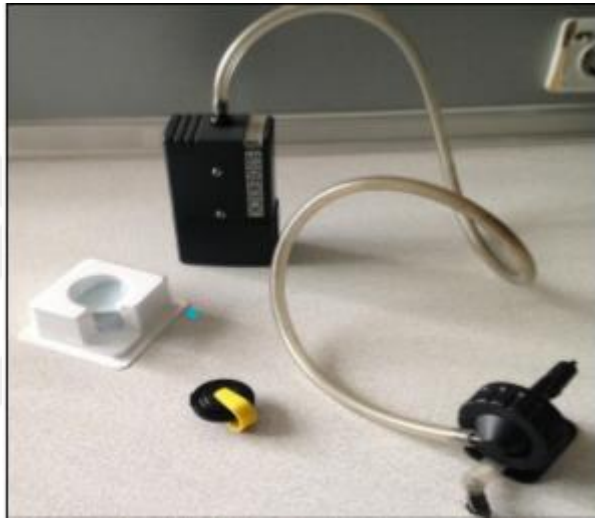
Resim 4.1 Kişisel hava örnekleme pompası, siklon başlık, PVC filtre ve filtre kaseti
