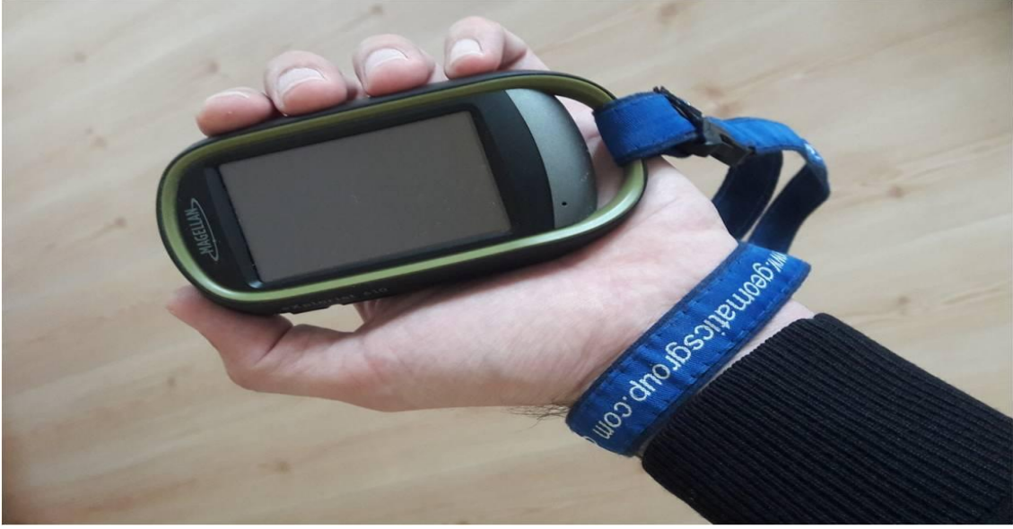
Resim 3.4. Koordinat ve rakım tespitinde kullanılan GPS cihazı (Çulha, 2019)
