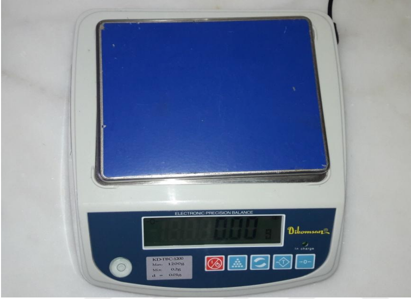
Resim 3.22. Meyve ve çekirdek ağırlıklarının ölçülmesinde kullanılan hassas terazi (Çulha, 2019)
