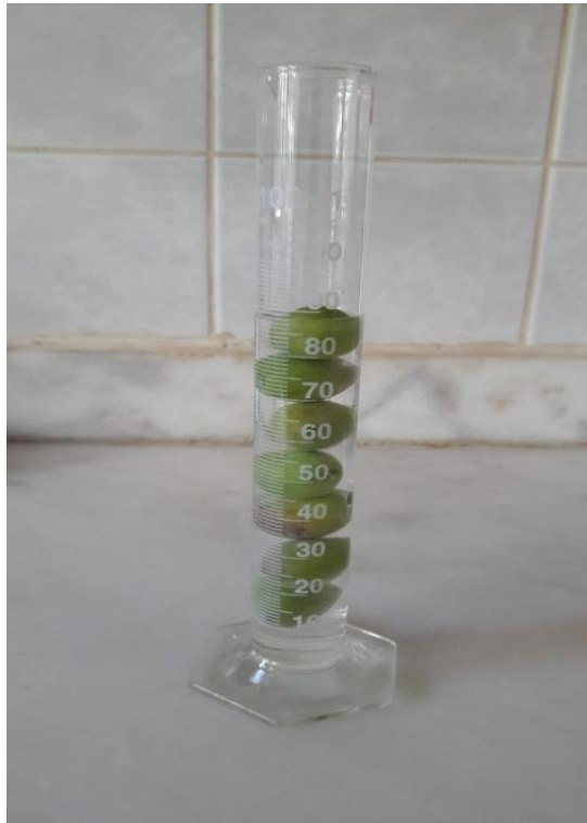
Resim 3.25. Mezur yardımıyla meyve hacimlerinin ölçülmesi (Çulha, 2019)
