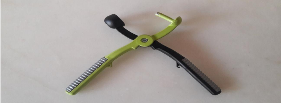
Resim 3.26. Meyve etinin çekirdeğinden ayrılmasında kullanılan aparat (Çulha, 2019)
