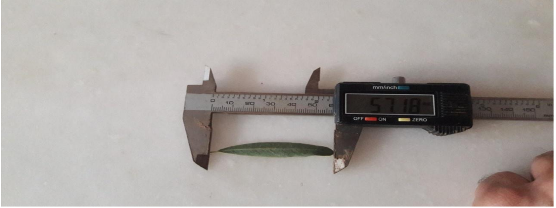
Resim 3.14. Dijital kumpas yardımıyla yaprak uzunluklarının ölçülmesi (Çulha, 2019)
