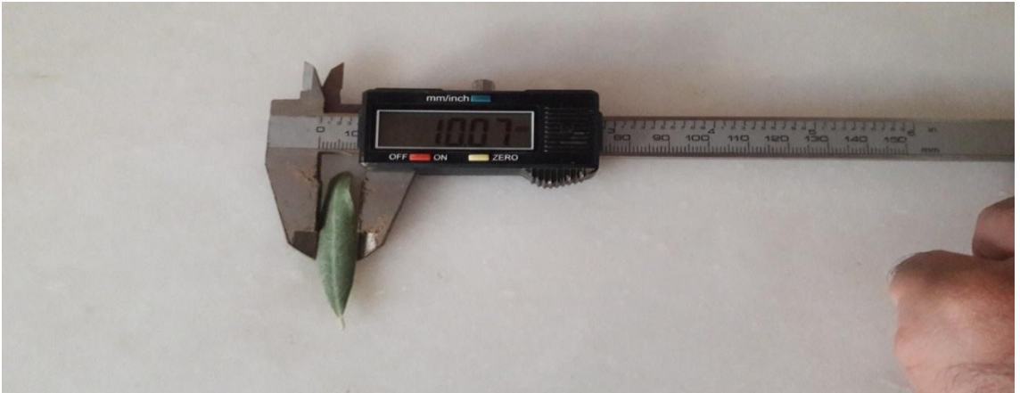
Resim 3.15. Dijital kumpas yardımıyla yaprak genişliklerinin ölçülmesi (Çulha, 2019)
