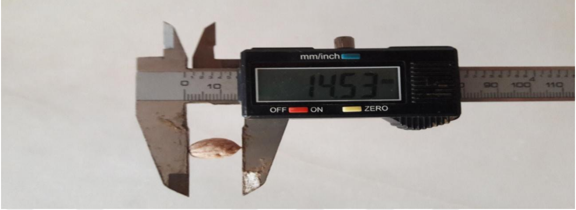
Resim 3.30. Dijital kumpas yardımıyla çekirdek boylarının ölçülmesi (Çulha, 2019)
