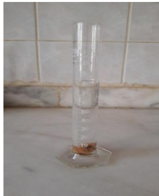
Resim 3.32. Mezur yardımıyla çekirdek hacimlerinin ölçülmesi (Çulha, 2019)
