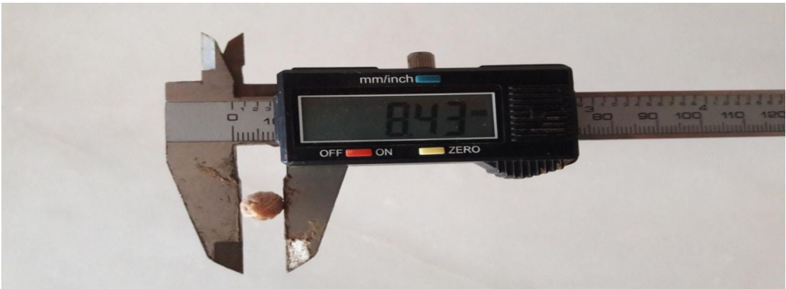
Resim 3.31. Dijital Kumpas yardımıyla çekirdek enlerinin ölçülmesi (Çulha, 2019)
