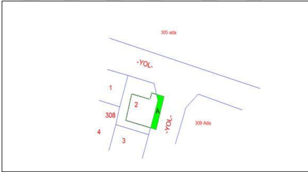
Şekil 3.6. Yola Tecavüzlü Yapı Örneği [15]
