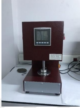
Resim 3.2 Prowhite kalınlık ölçüm test cihazı
