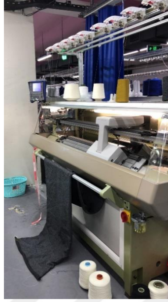
Resim 3.1 Kumaşların üretiminde kullanılan düz örme makinası
