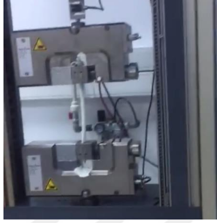
Resim 3.8 Zwick Roell Z010 mukavemet test cihazı
