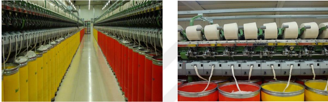
Resim 2.4 OE iplik tesisi genel görünümü [24] ve bobinleme ünitesi [25]_(a) Genel görünüm (b) Bobinleme ünitesi)
