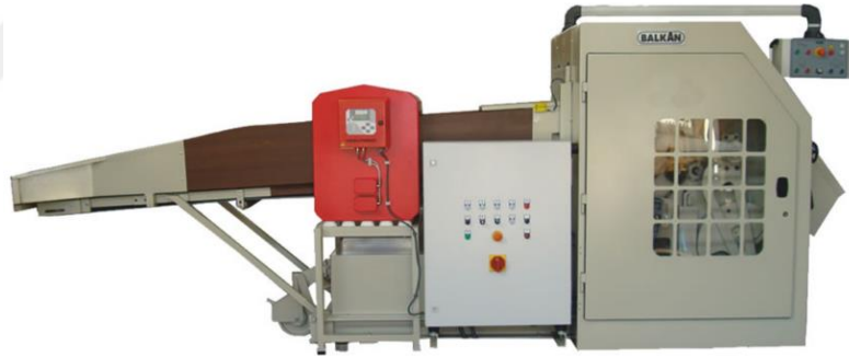
Resim 2.1 Balkan marka kumaş kesim makinası [20]
