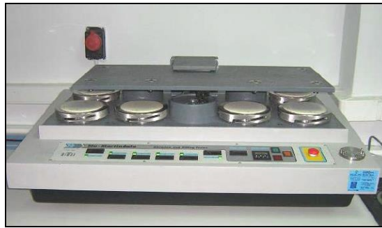
Resim 3.7 Martindale boncuklanma ve aşındırma test cihazı
