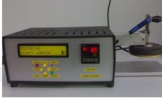
Resim 3.4 Alambeta ısıl özellikler ölçüm test cihazı
