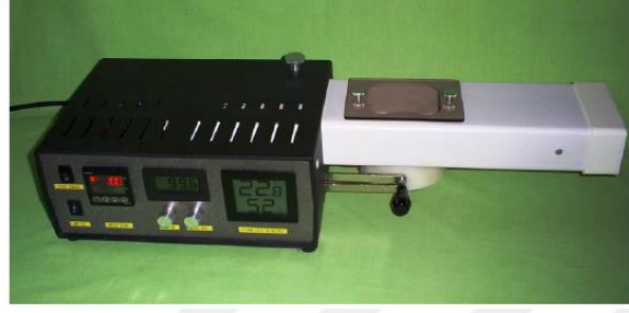
Resim 3.5 Permetest su buharı geçirgenliği test cihazı [68]
