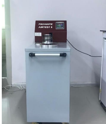
Resim 3.3 Airtest II hava geçirgenliği test cihazı
