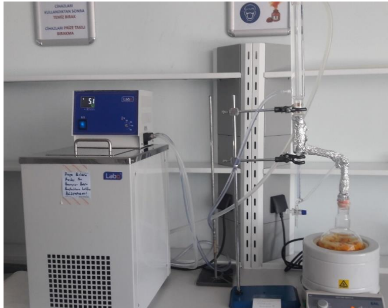
Resim 3.1 Hidrodistilasyonun yapıldığı clevenger düzeneği
