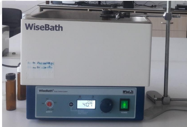
Resim 3.9 Vial tüplerin sıcak su banyosunda sabit sıcaklıkta ısıtılması
