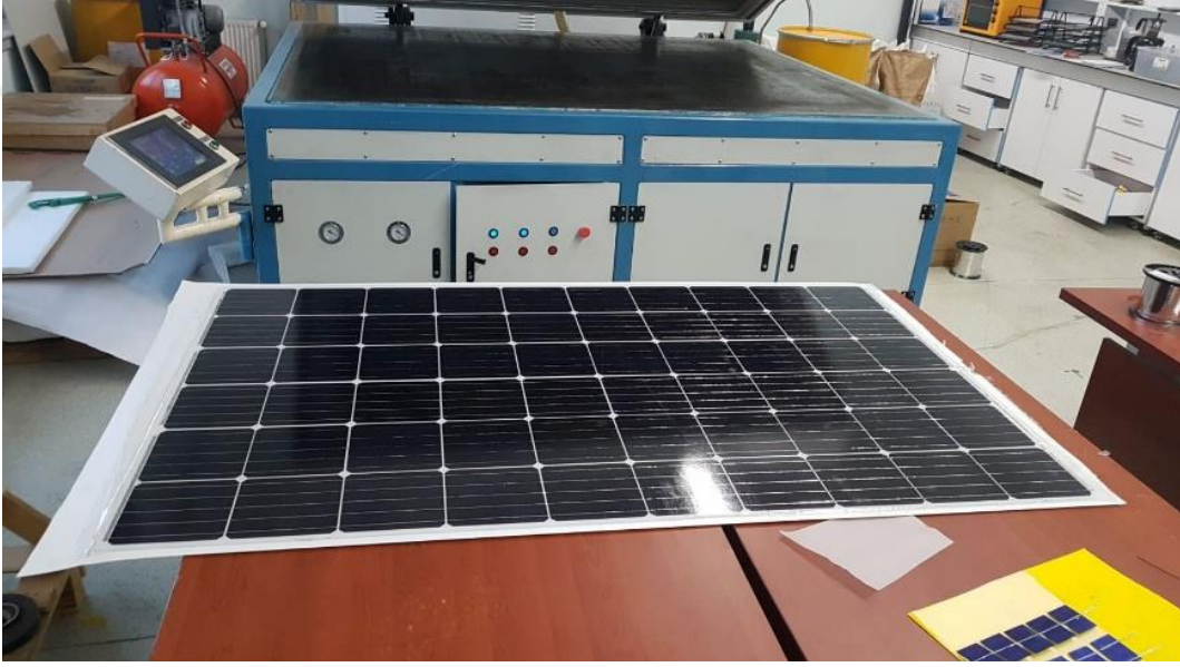
Resim 5.2. 4 Güneş hücrelerinin laminasyonu ile PV panel üretilmesi
