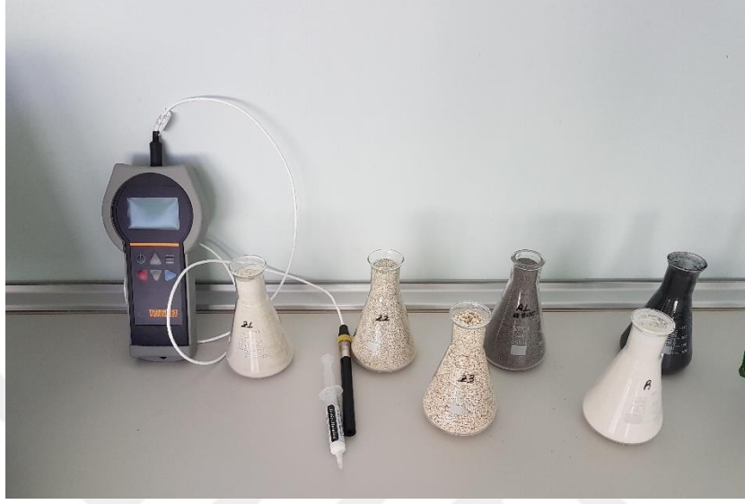
Resim 5.1. 2 Saf malzemelerin ısı iletkenlik ölçümleri
