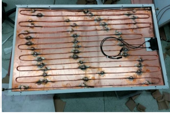
Resim 6. 1 PV modülün arkasına bakır levhanın birleştirilmesinin görünümü
