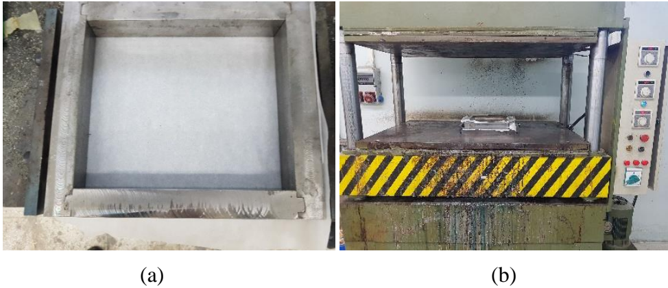
Resim 5.4. 2 Plakanın kalıp içerisinde hazırlanması
