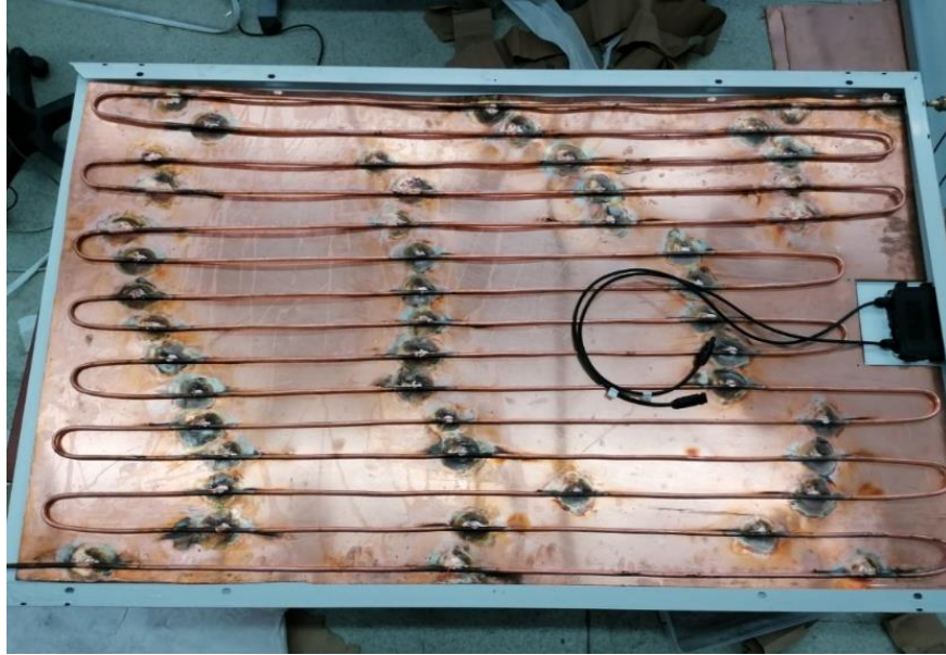
Resim 5.3. 1 PVT bakır serpantinleri üretim aşamaları
