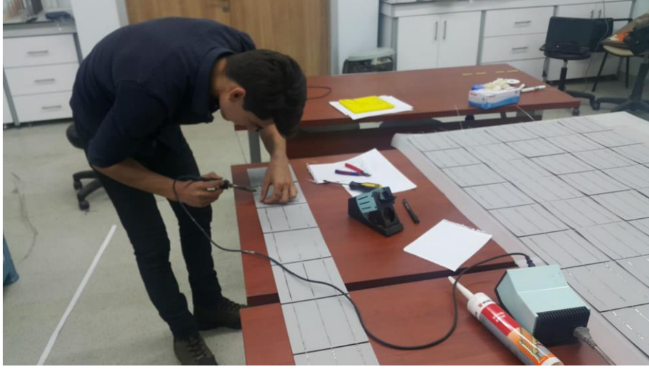
Resim 5.2. 2 Güneş hücrelerinin panel yapımı için seri ve paralel bağlanması
