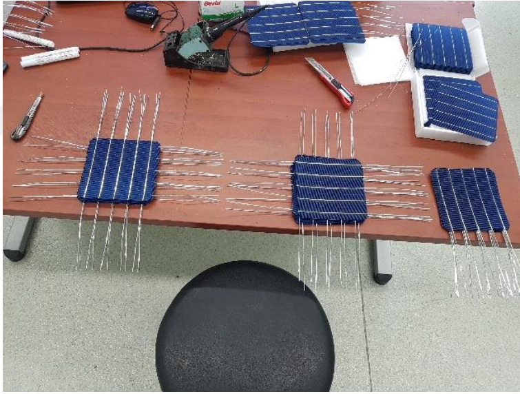
Resim 5.2. 1 Güneş hücrelerinin panel yapımı için hazırlanması
