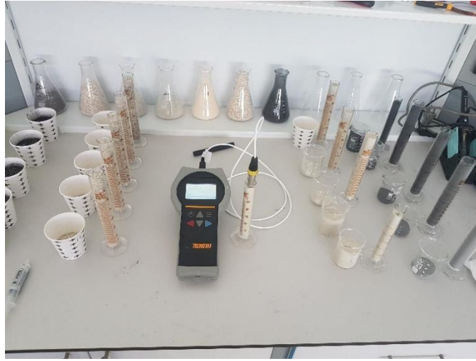
Resim 5.1. 3 Karışım malzemelerinin ısı iletkenlik ölçümleri
