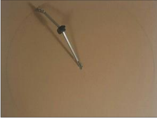
Belirlenen ölçünün merkez noktası belirlenir ve pergel yardımı ile daire çizilir.
