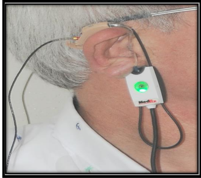
Şekil 12. İşitme kaybına uyarlanan işitme cihazının kazancının REM ile denetlenmesi.
