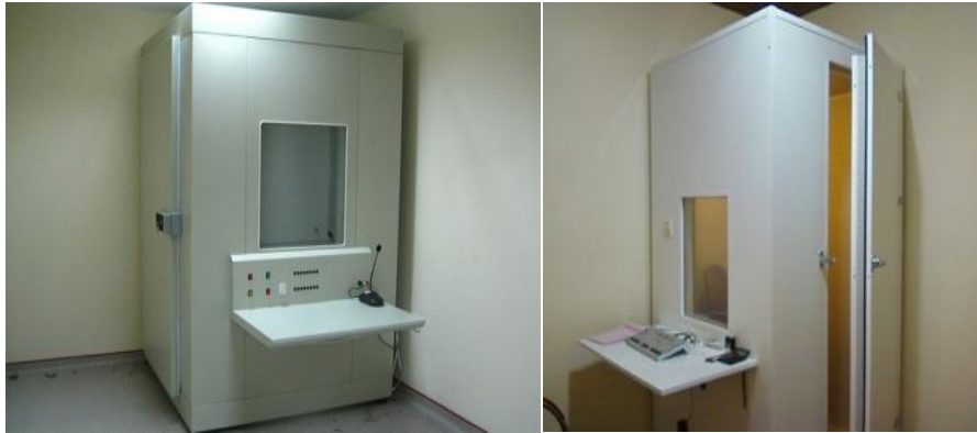
Resim 15: Saf Ses Testinde Kullanılan Sessiz Kabinler (61).
