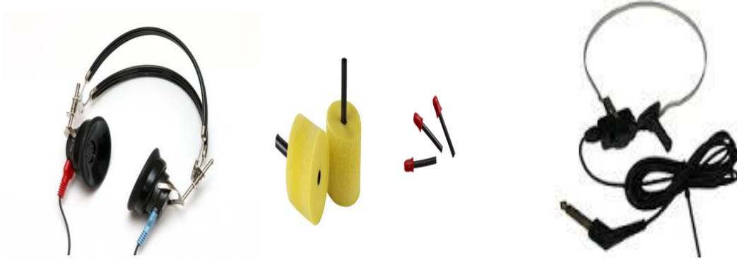
Resim 16: Hava ve Kemik Yolu Ölçümünde Kullanılan Kulaklıklar ve Kemik Vibratör (60).
