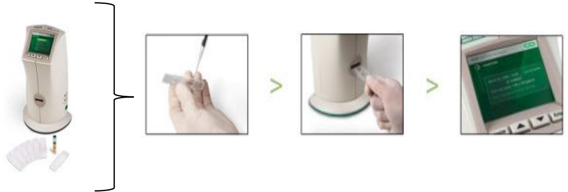
Şekil 9. Bio-Rad's New TC10™ Automated Cell Counter'da hücre sayım aşamaları
