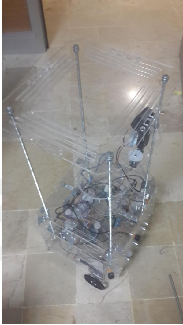
Şekil 81: Artık gijonların kesiminin tamamlanması
