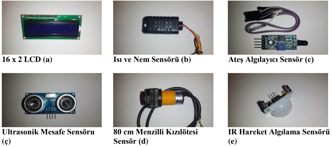
Şekil 8: Sistemde kullanılan sensörler ve sensör değerleri test ekranı
