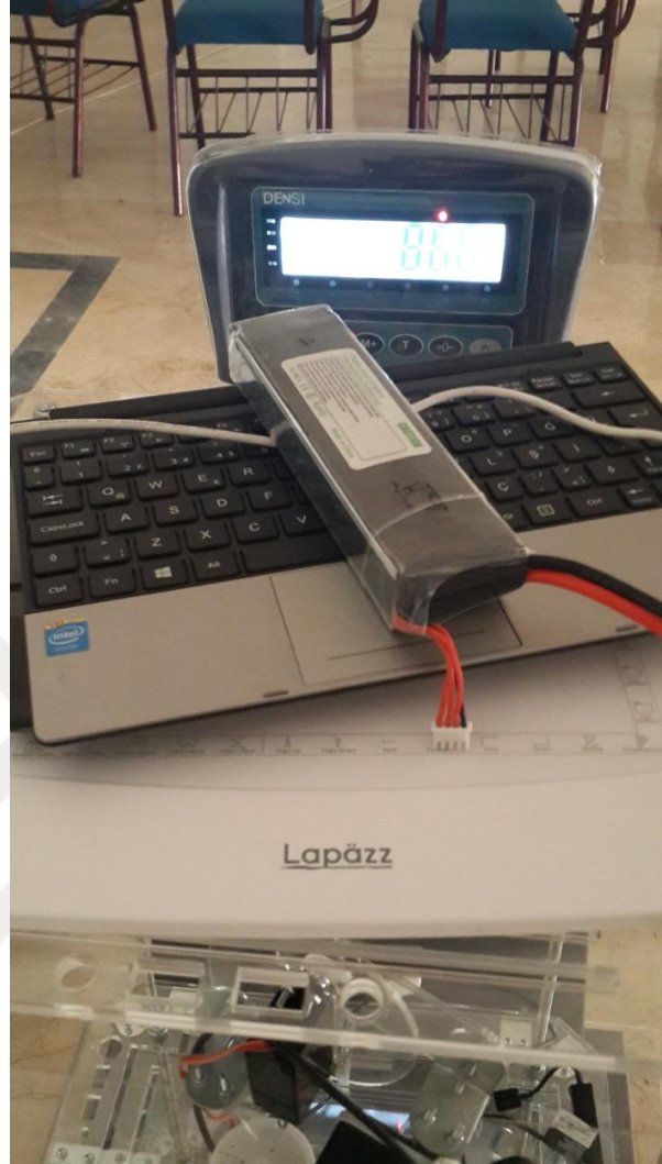
Şekil 17: HEduBot ağırlık değerlerinin ölçümü
