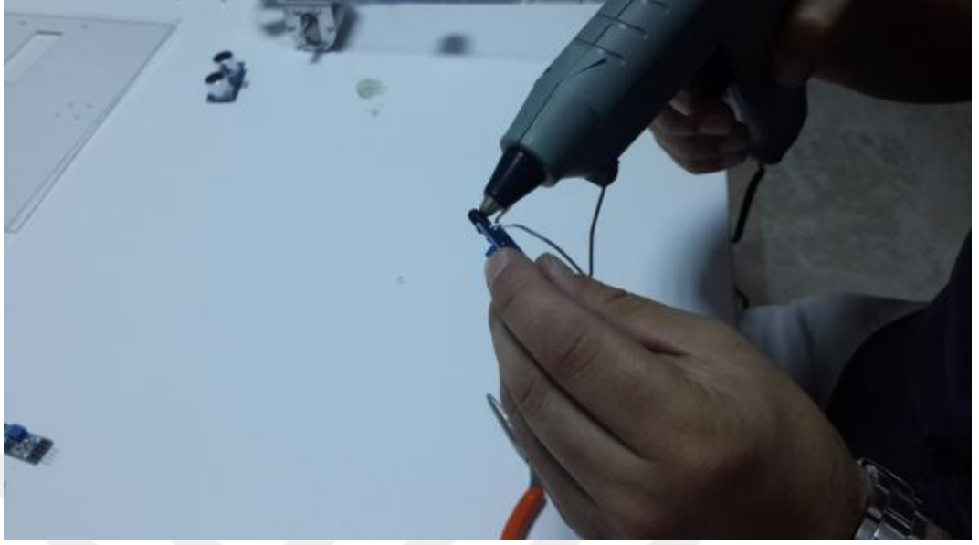
Şekil 43: Sensörlerin silikon ile yan panellere montajı (b)
