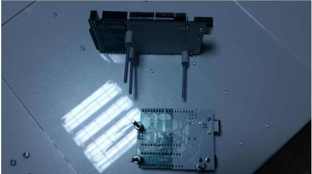
Şekil 40: Plastik aralayıcıların kartlara montajı
