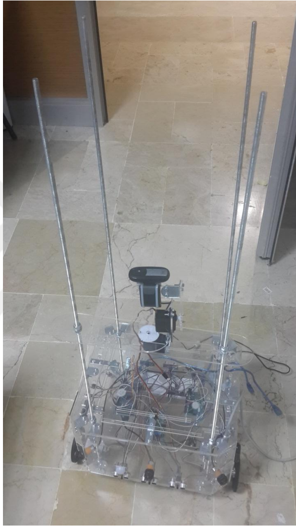
Şekil 76: Gijon ve kamera katmanı montajı
