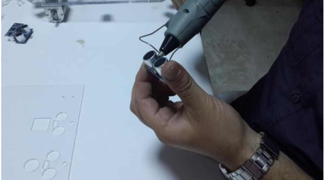
Şekil 42: Sensörlerin silikon ile yan panellere montajı (a)
