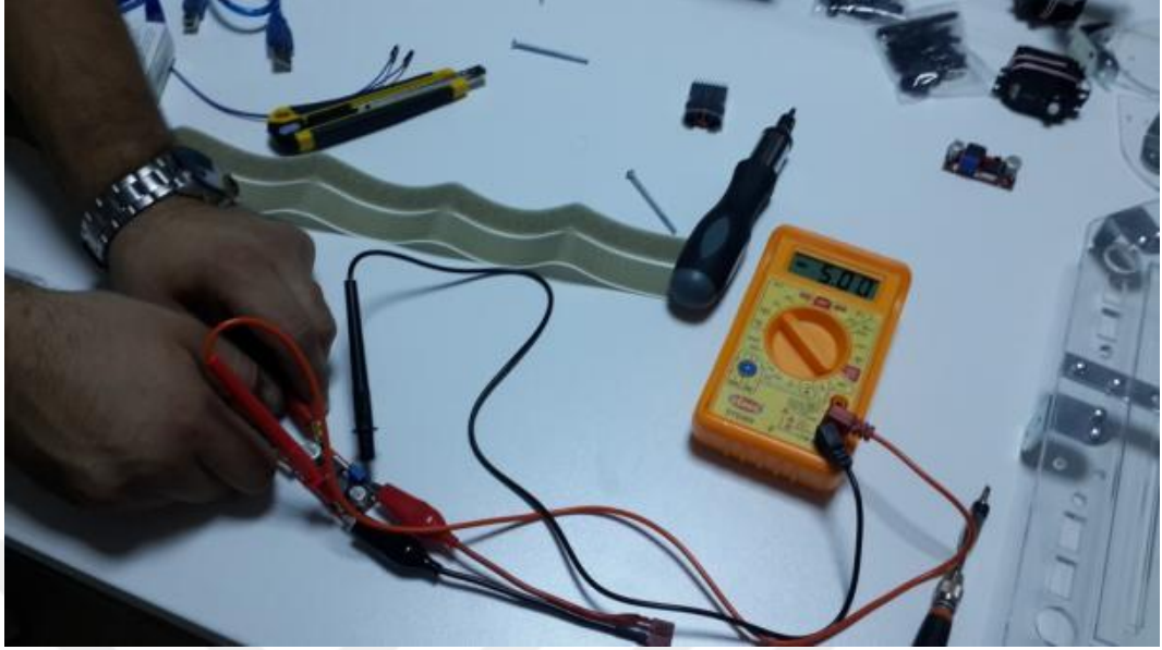
Şekil 58: Step down voltaj regülatör kartının 5v'a ayarlanması
